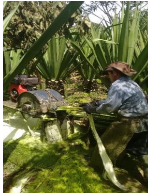
Figura 1. Proceso de desfibrado de la hoja de fique.
