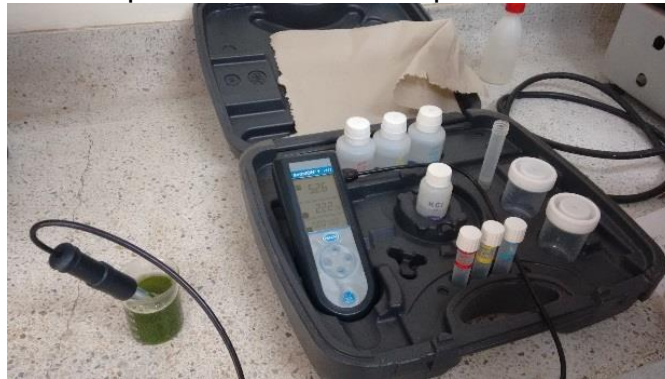
Figura 3. Equipo utilizado para la obtención del pH.
