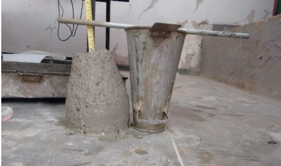
Figura 8. Ensayo de trabajabilidad cono de Abrams.
