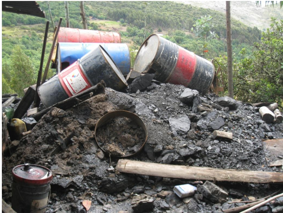
Foto 50. Fallas en el almacenamiento de residuos peligrosos y deficiencias en el almacenamiento de residuos sólidos.
