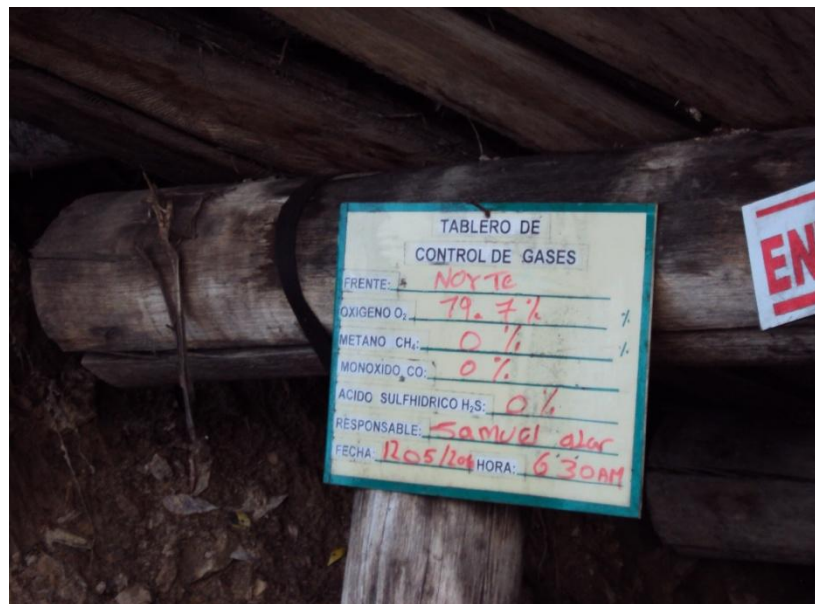
Foto 7. Tablero rudimentario de control de medición de gases en una mina subterránea.
