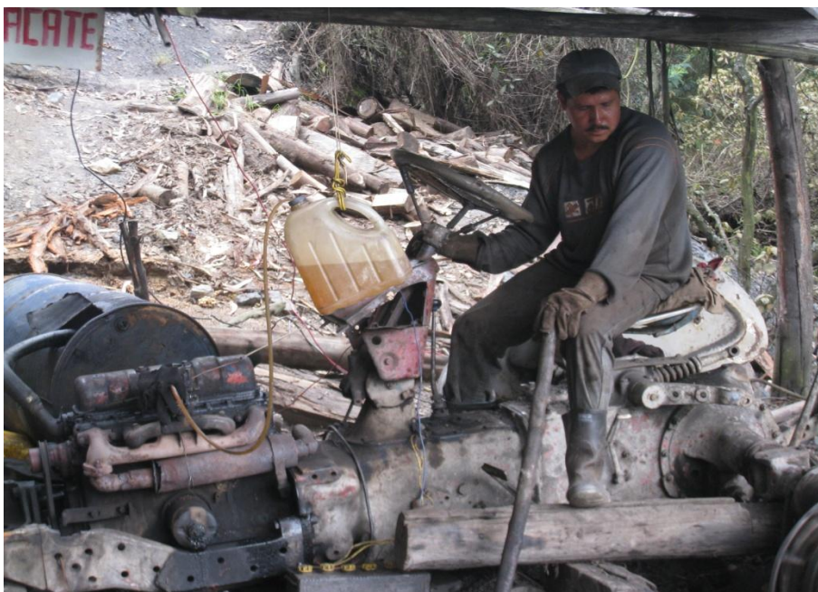
Foto 29. Se observa un recipiente de diesel colgando el cual abastece el motor, situación altamente en riesgo para el trabajador.
