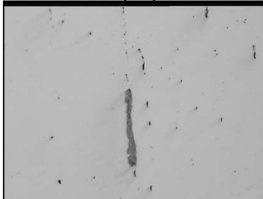
Figura 13. Inclusiones no metálicas de sulfuros, serie gruesa, nivel 2 y óxidos globulares, serie gruesa, nivel 2, sin ataque químico a 100X.
