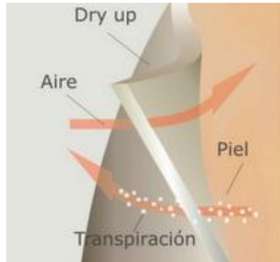
Figura 89. Esquema funcionamiento de tecnología Dry
