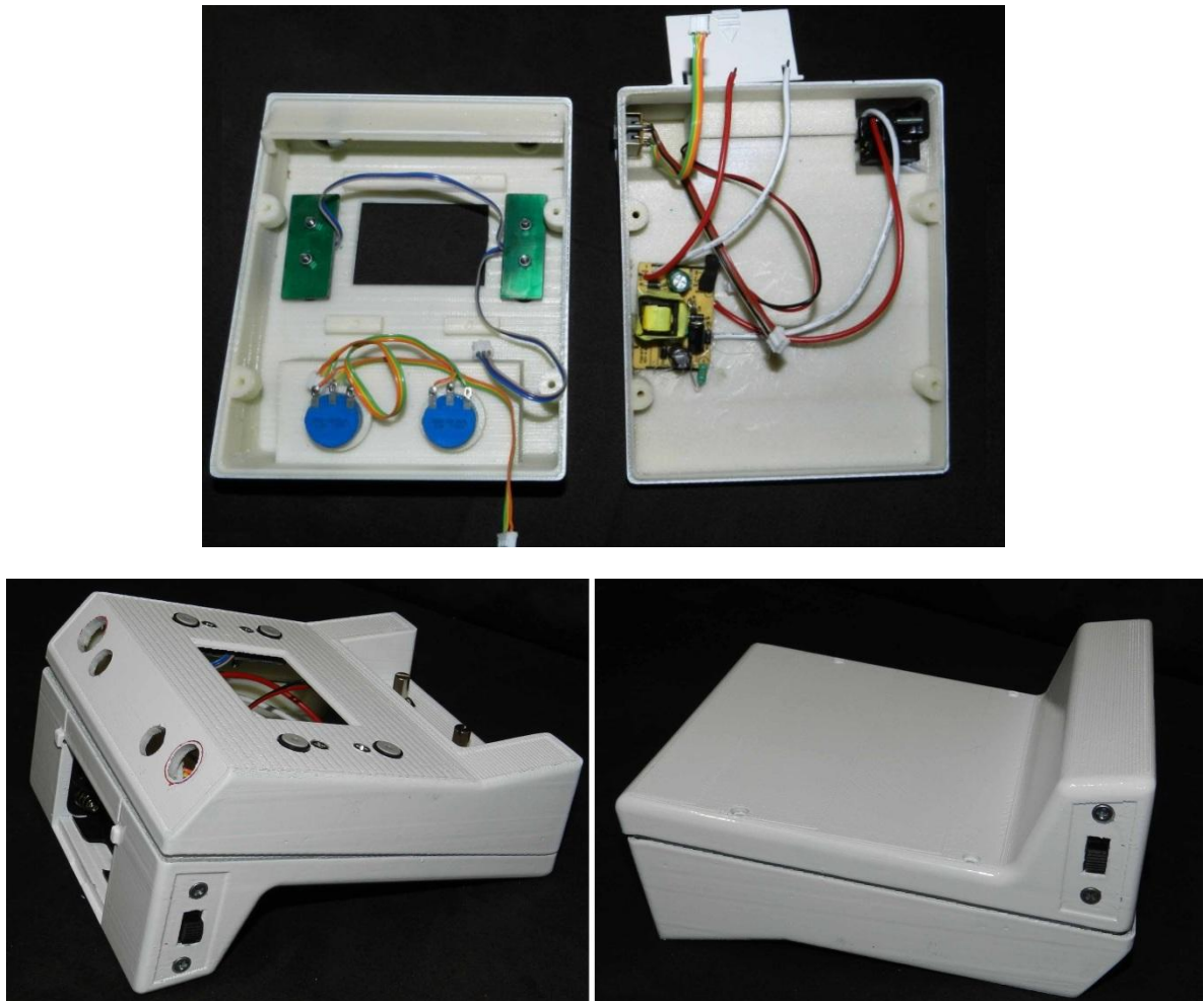
Figura 132. Distribución componentes electrónicos al interior de carcasa.
