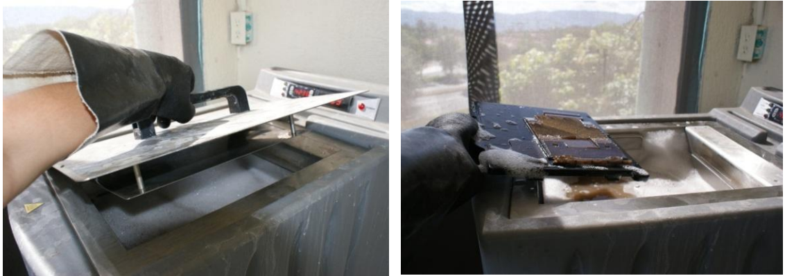
Figura 130. Remoción de material de aporte por baño
