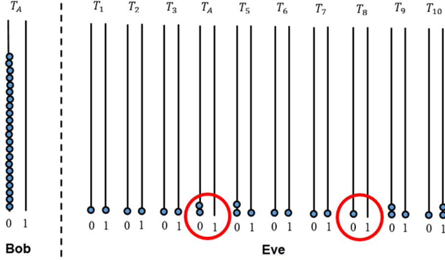
Figura 18. Ejemplo del evento del ataque 2\_1 para Eve, para M=10 posibles retardos de tiempo junto con el conteo de fotones recibido por Bob, para un envío de un bit 0 con 22 fotones por parte de Alice. Cada bola azul es una representación pictórica de un fotón.
