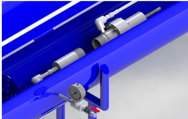
Figura 64. Subsistema de control de presión.
