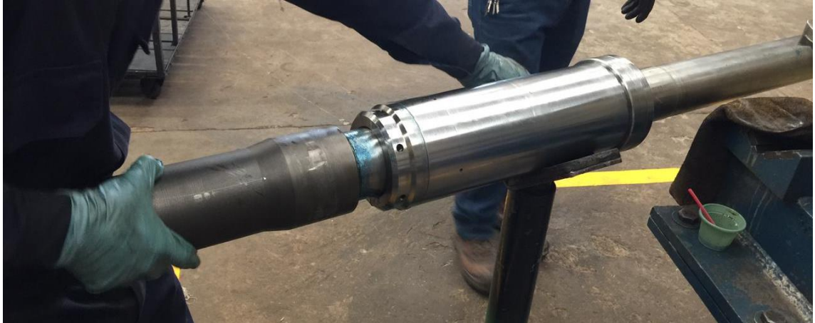
Figura 61. Construcción del packer (Imagen 2).
