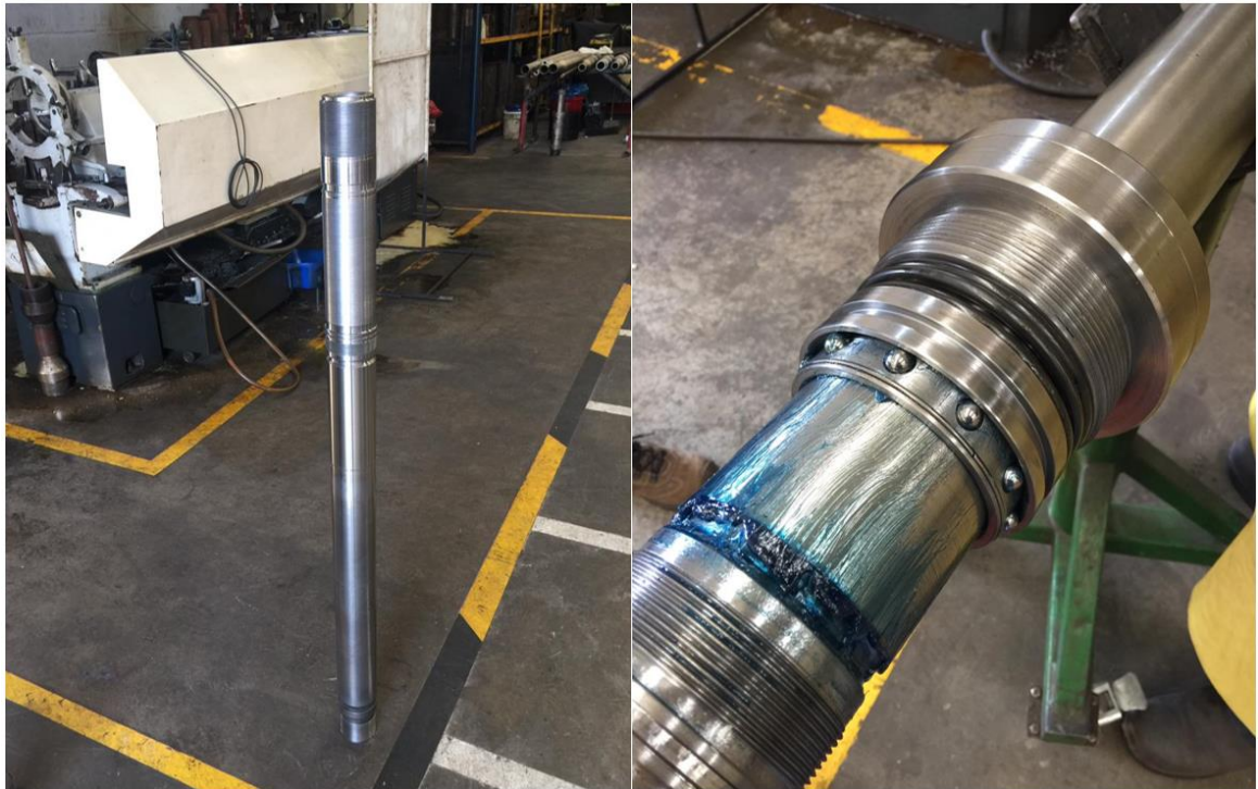
Figura 60. Construcción del packer (Imagen 1).
