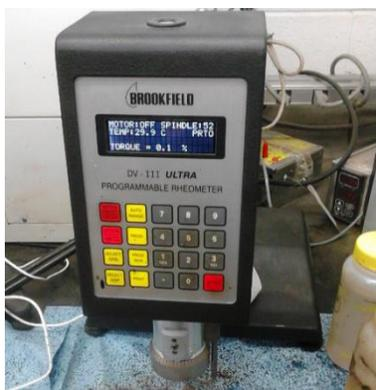
*Figura 23.* Viscosímetro Brookfield modelo LVDV-III Ultra ubicado en los laboratorios PERM. Inc.
