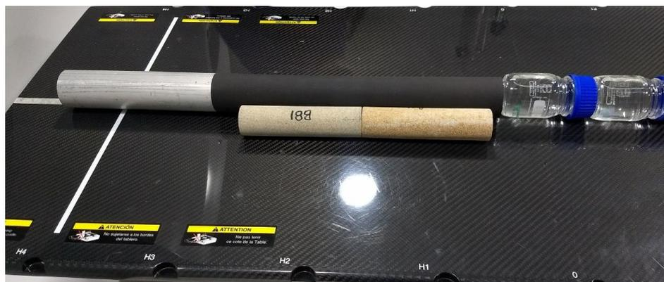
Figura B.791. Materiales estándares escaneados para construir la curva de calibración
