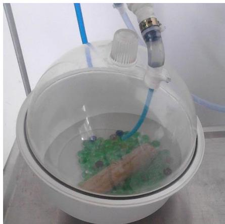
*Figura B.1.* Montaje para la saturación con salmuera al vacío
