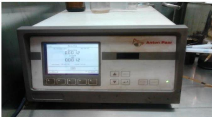
Figura 21. Densímetro Anton Parr DMA 4100 ubicado en los laboratorio de PERM.inc
