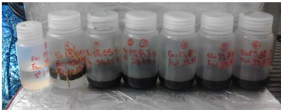
*Figura A.4* Efluentes resultantes de la saturación con aceite extrapesado
