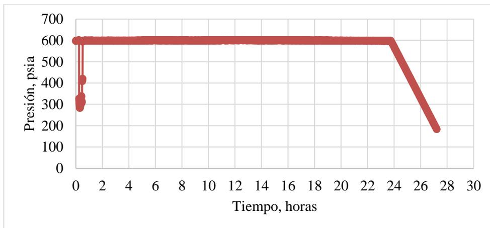
Figura A.9. Comportamiento de la presión durante la etapa de inyección y remojo del segundo ciclo.
