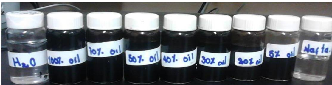
Figura 26. Muestras de las diferentes mezclas crudo-nafta.
