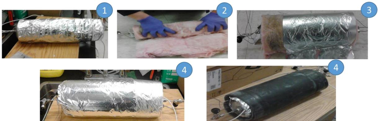
Figura 44. Adecuaciones térmicas antes del proceso de inyección de crudo pesado
