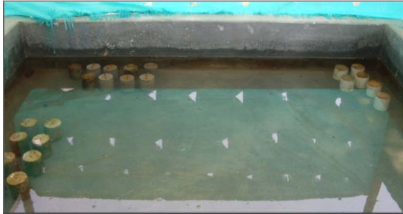
Figura 1. Probetas de concreto sumergidas en una solución salina del 3%
