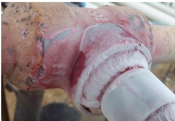
Figura 56. Examen del revelado de las tintas penetrantes en la T del eje de la bomba
