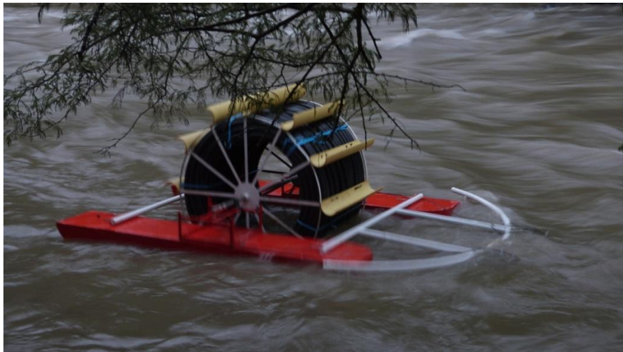
Figura 46. Bomba de rueda sostenida por guayas
