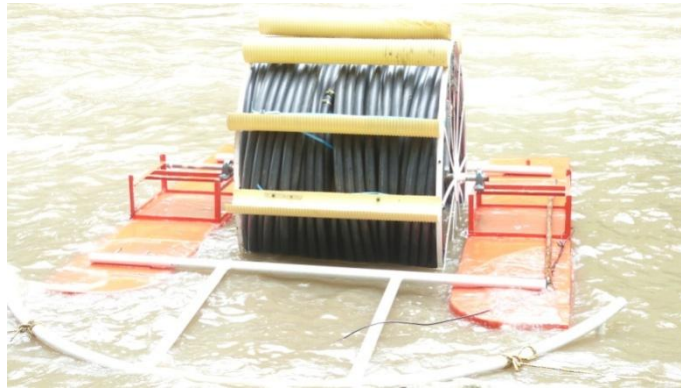
Figura 47. Bomba ubicada en el cauce del rio
