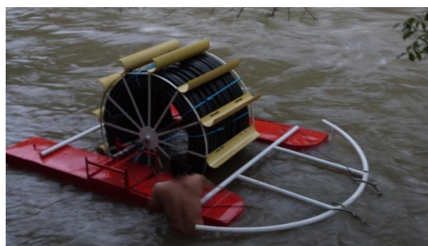
Figura49. Revisión visual de la bomba
