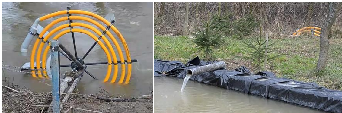
Figura 4. Modelo de una Bomba de rueda para captación de agua.
