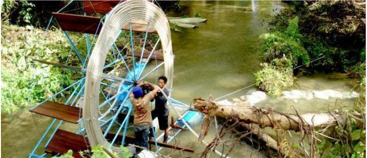
Figura 5. Bomba de caracol, Bulasat Indonesia (Aumenta la disponibilidad de agua potable).
