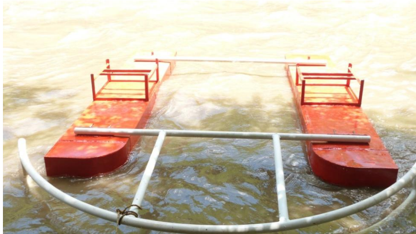
Figura 45. Estructura soporte bomba en el rio
