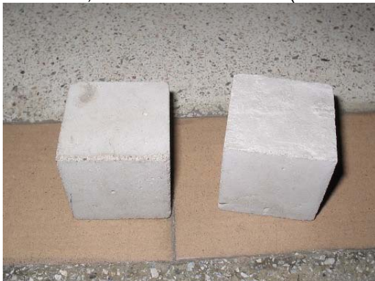
Cubos de concreto, superficie lisa.
