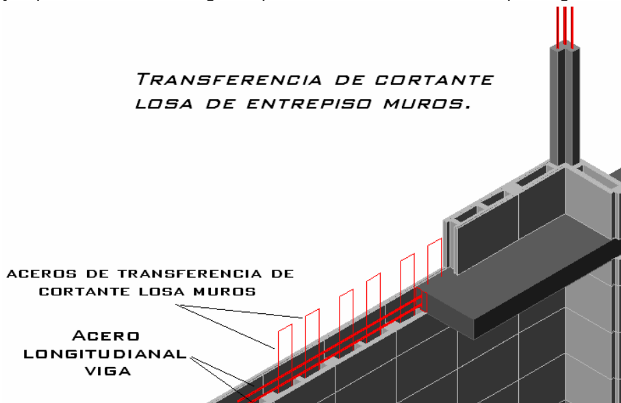
FIGURA 133. DETALLE UNIÓN LOSA ENTREPISO MURO PARA TRANSFERENCIA DE CORTANTE, ACEROS DE TRANSFERENCIA.
