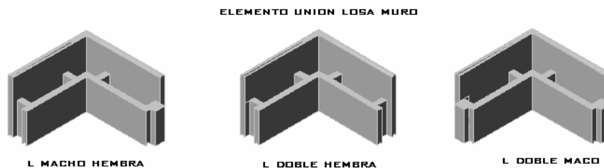
FIGURA 20. ELEMENTOS L UNIÓN LOSA MURO EXTERIORES
