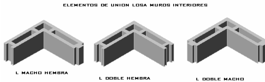
FIGURA 23. MEDIDAS BLOQUES REMATE UNIÓN LOSA MUROS INTERIORS
