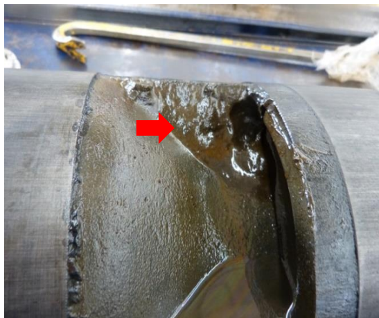
Figura 40 Vista externa conjunto de etapas. Evidencia de depósitos de arcilla con alto contenido de finos
