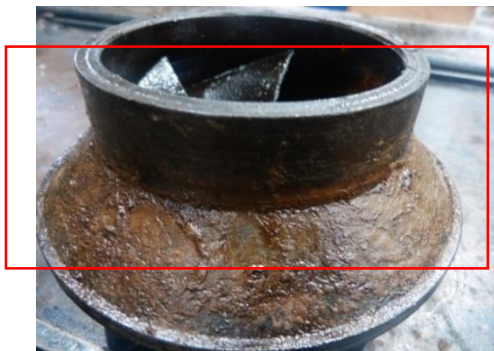
Figura 56 Impulsores registran desgaste libre en las áreas de estabilización en empuje descendente (downthrust).
