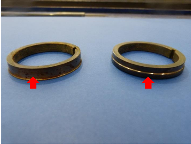
Figura 43 Espaciadores de base y cabeza registran desgaste radial severo, signo de manejo de abrasivos
