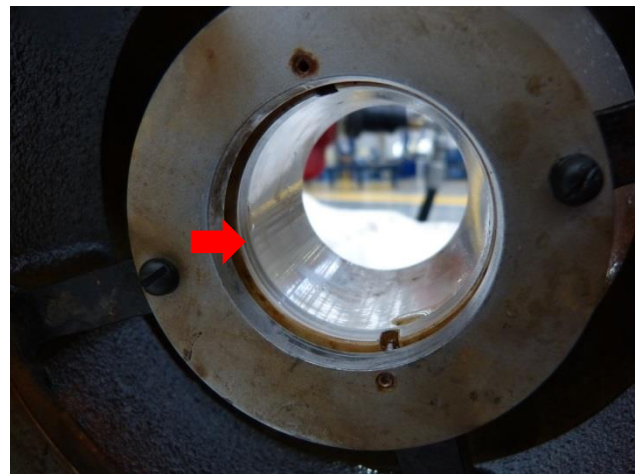
Figura 41 Cabeza. Formación de un hombro en el extremo que registra el desgaste significativo del bushing de estabilización
