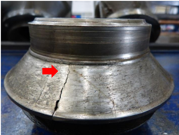
Figura 44 Etapa extremo superior. Desgaste severo y pérdida de material en superficies downthrust
