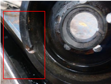
Figura 55 Impulsor cercano a la cabeza con pérdida de material por corrosión en superficies upthrust.
