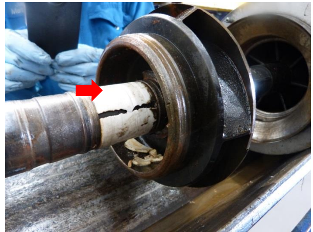
Figura 45 Etapa #5. Fractura en sleeve de estabilización, fragmentos del componente en el interior de las etapas
