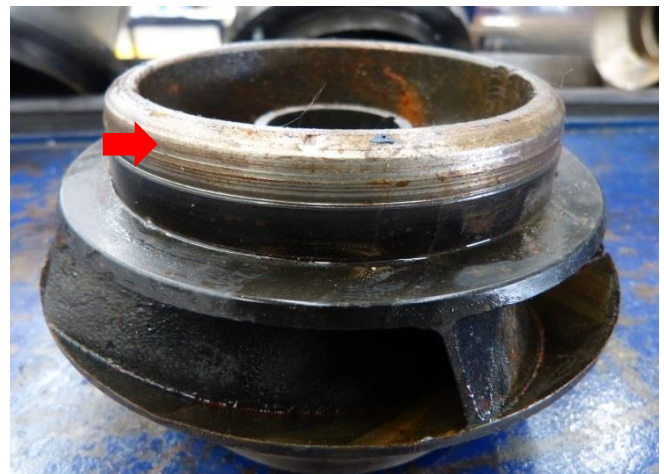
Figura 46 Impulsor extremo superior. Desgaste severo en superficies upthrust por pérdida de estabilización radial
