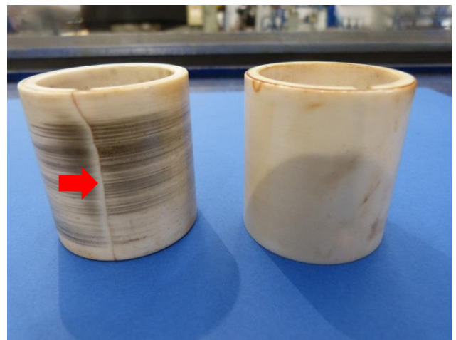
Figura 42 Sleeves base y cabeza. Desgaste radial severo en superficies de fricción, fisura en cojinete de la cabeza
