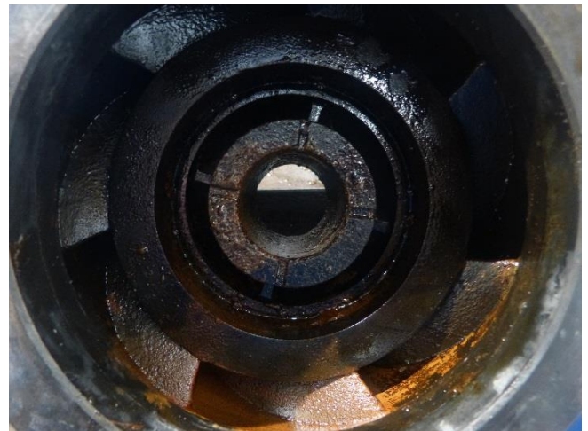
Figura 54 Etapas Std presentaron incrustación en las áreas de estabilización
