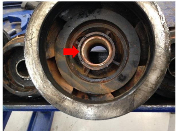
Figura 50 Difusor, vista interna. Desgaste moderado del Bushing de Zirconio.
