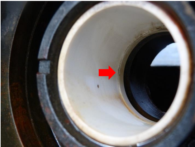
Figura 47 Difusor ARZ, desgaste radial severo en bushing de estabilización de zirconia.
