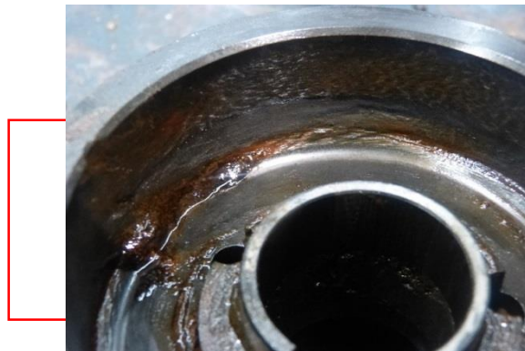
Figura 58 Vista en detalle de los surcos o canales formados sobre las superficies de impulsores
