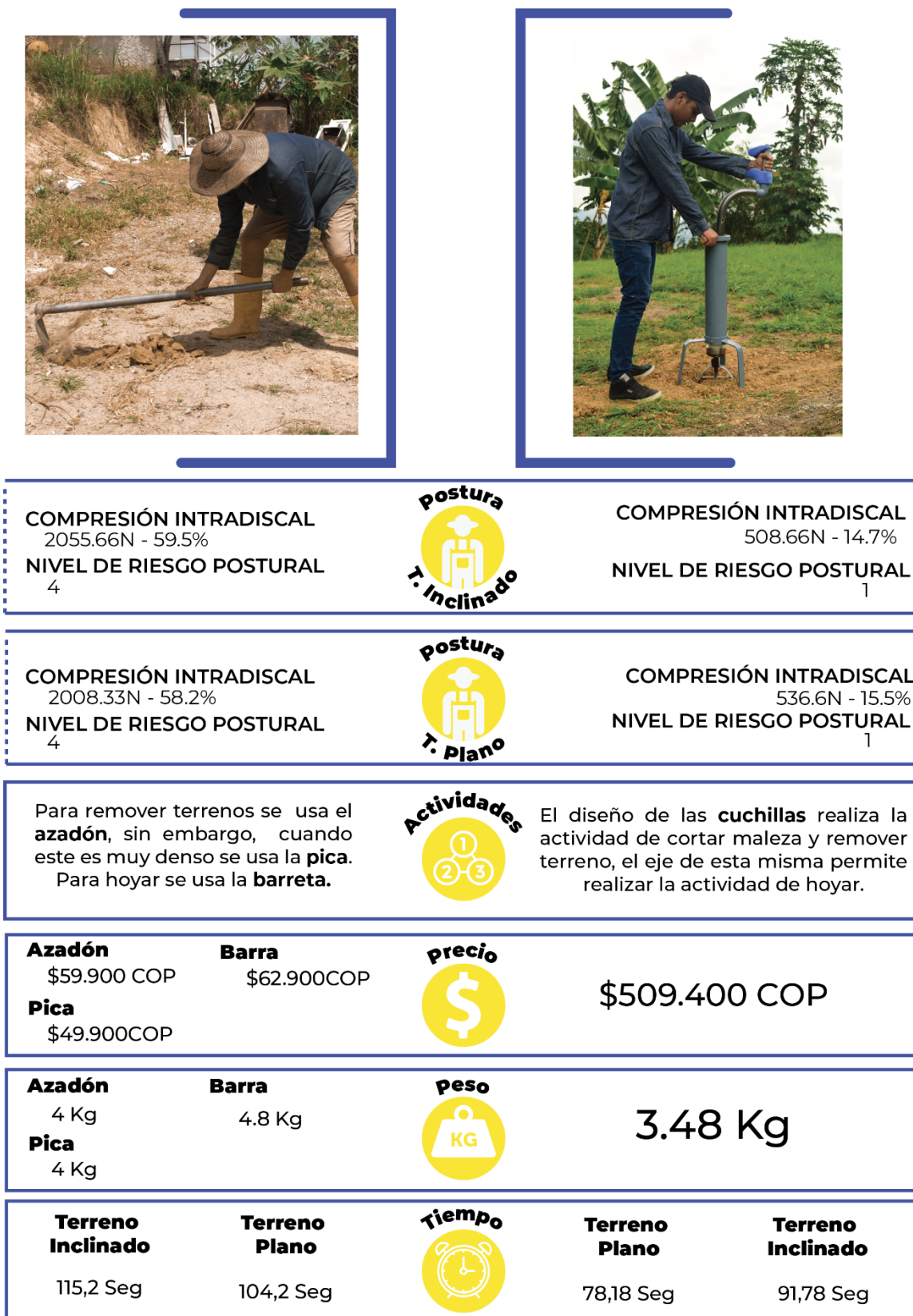
Figura 94. Cuadro comparativo. Azadón Vs. Dispositivo diseñado.
