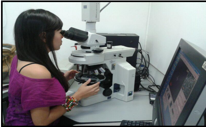
Figura 16: Microscopio de luz polarizada analizada Nikon utilizado para realizar el conteo de puntos de las secciones delgadas.
