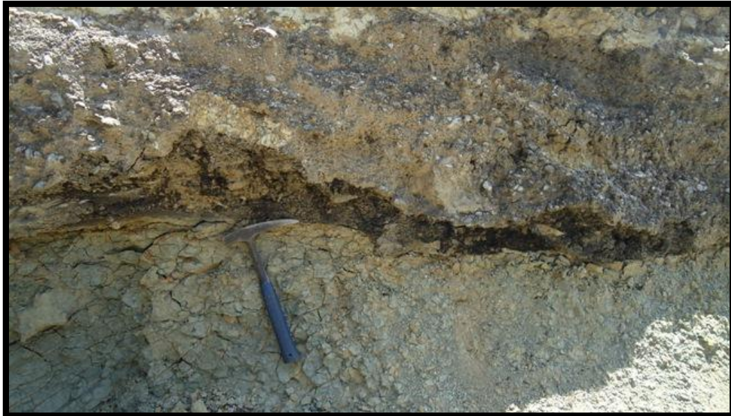
Figura 33: Detalle perteneciente a la región A. Arenisca Conglomerática con impregnación de bitumen. Fotografía con azimut de 200°.
