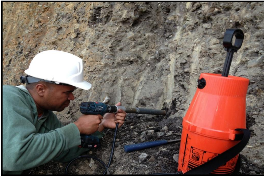
Figura 19: Toma de Plugs en campo mediante taladro eléctrico.
