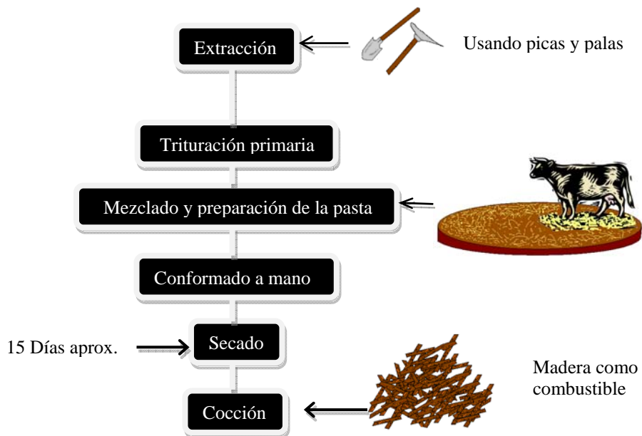
Figura 11. Diagrama del proceso de fabricación de tejas y ladrillos en Barichara (S/der)
