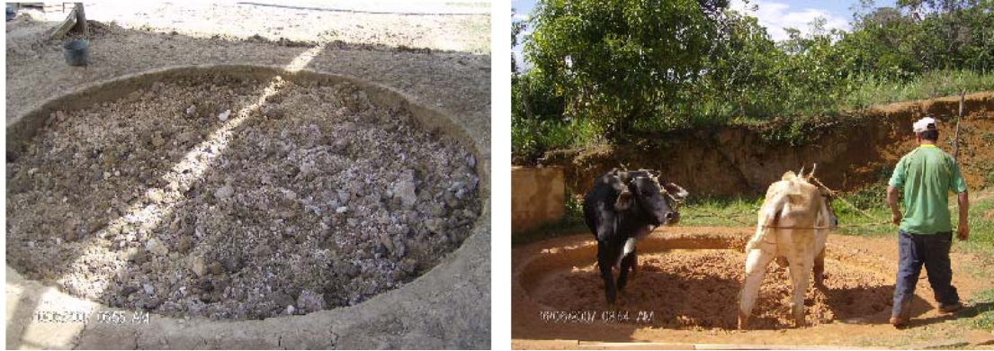
Figura 13. Pilas de disgregación de arcilla.
