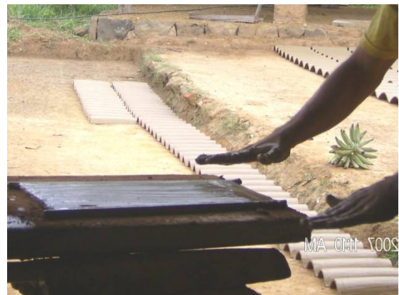
Figura 15. Moldeo manual de tejas.
