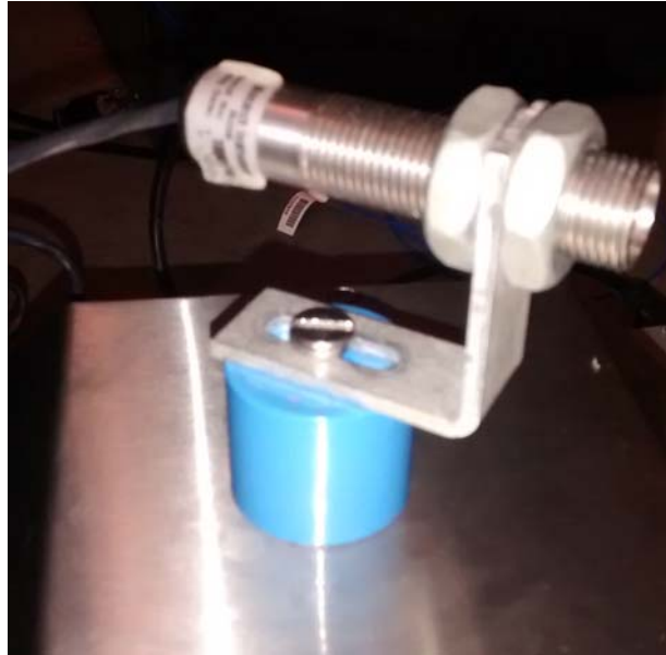
Figura 17. Láser infrarrojo – analizador de vibraciones
