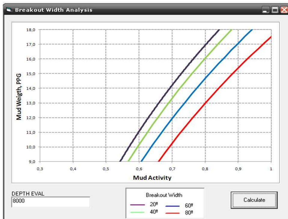
Figura 7-22. Ancho de Breakout como función del peso de lodo y de la actividad del lodo.
