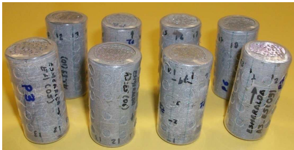
Figura 2-15. Núcleos de Formación Esmeralda. Muestras tomadas de afloramiento vía Barranca. Utilizados para la caracterización mecánica UCS inicial.
