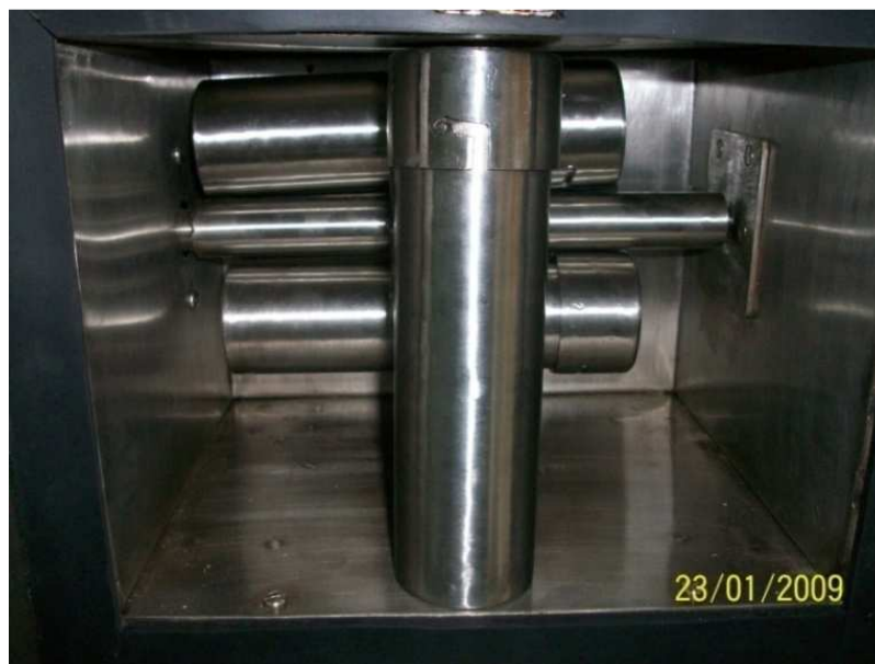
Figura 4-12. Celda de envejecimiento diseñada durante el desarrollo de este trabajo para los núcleos y para los discos.
