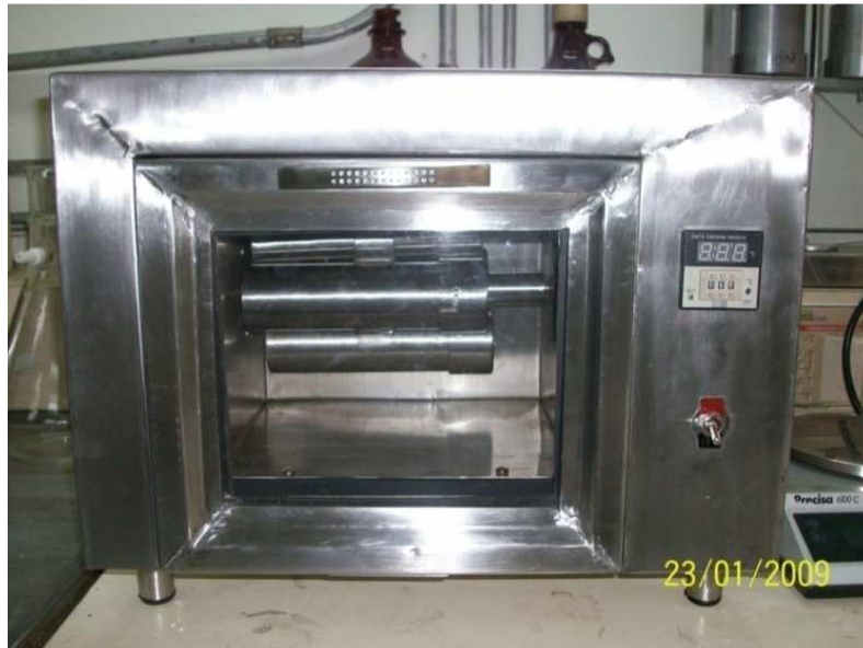
Figura 4-13. Equipo de rolado diseñado durante el proyecto. Compuesto por 4 cilindros en donde están inmersas las probetas con control de Temperatura.
