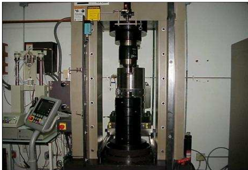
Figura 2-23. Fotografía equipo MTS modelo 815 del Laboratorio Mecánica de Rocas ICP.
