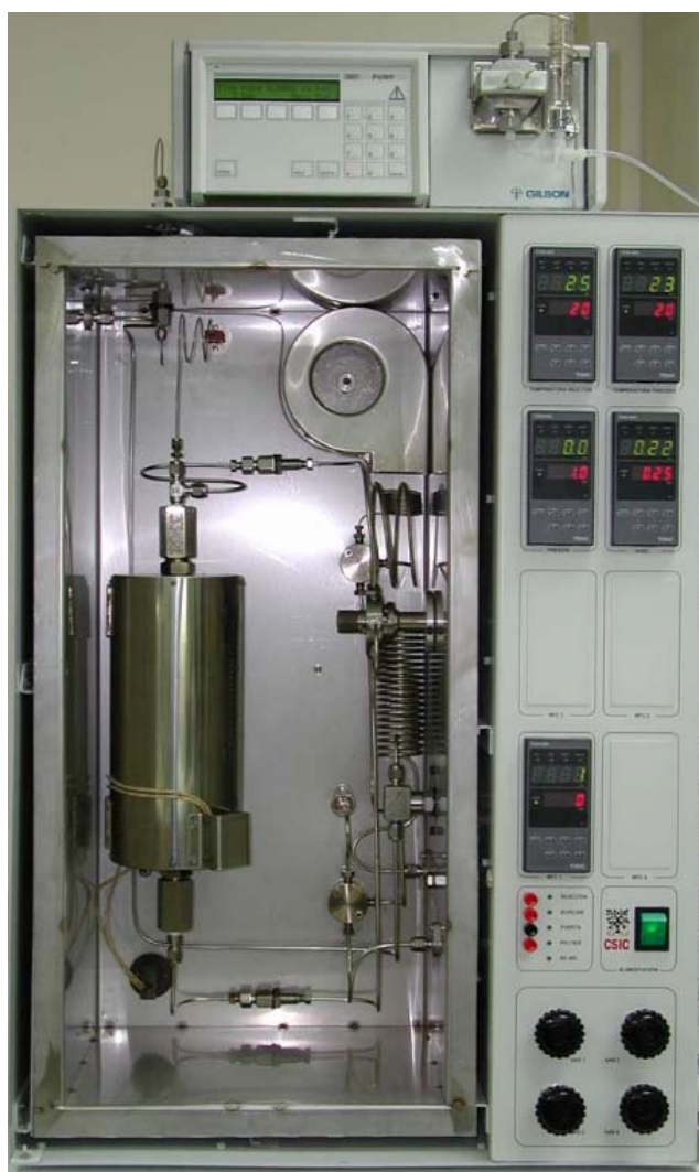
Figura 9. Configuración interna de la unidad de reacción Microactivity-PRO.
