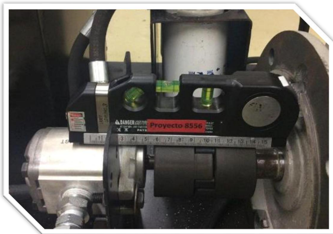
Figura 33. Alineación motor bomba con acople flexible
