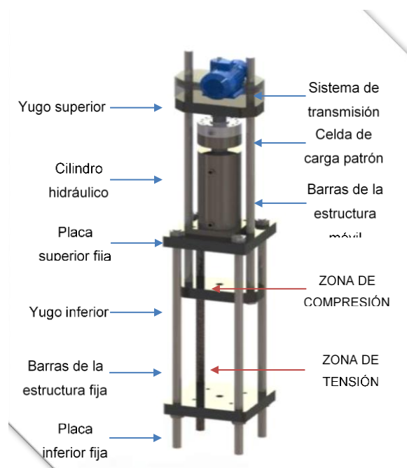
Figura 41. Estructura de calibración MCU
