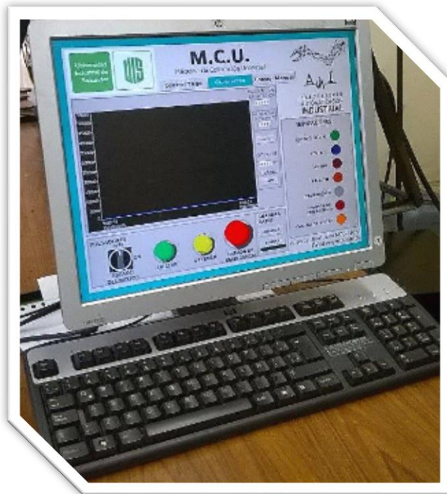
Figura 64. HMI de la MCU
