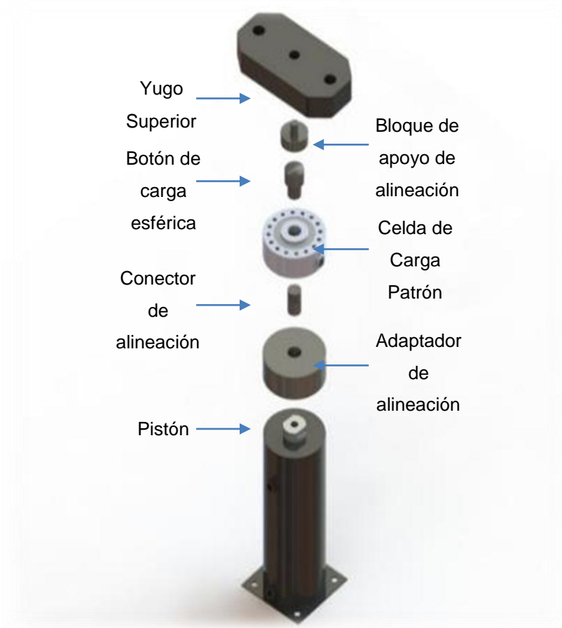
Figura 47. Explosión del montaje de la celda de carga patrón
