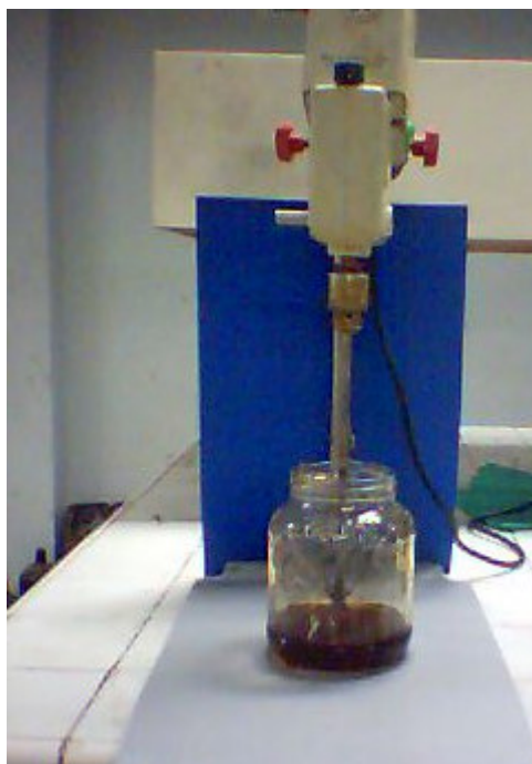
Figura 7. Montaje de homogenización para el caucho-estireno.
