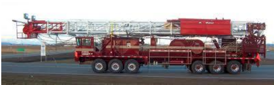
Figura 4. Equipo de Reacondicionamiento de pozos 21
