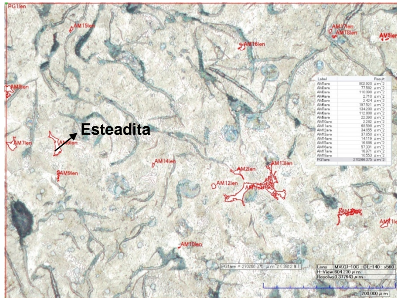
Figura 22. Micrografia a 560x – Medicion de Esteadita
