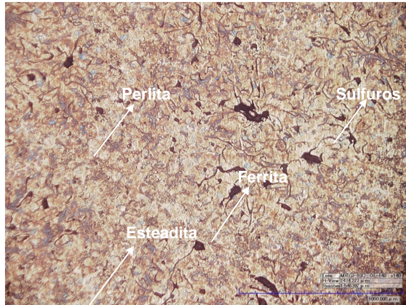
Figura 20. Micrografia a 140x
