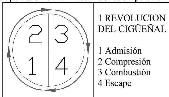
**Figura 24. Ciclo de operación de un motor de 4 tiempos/carreras.**
