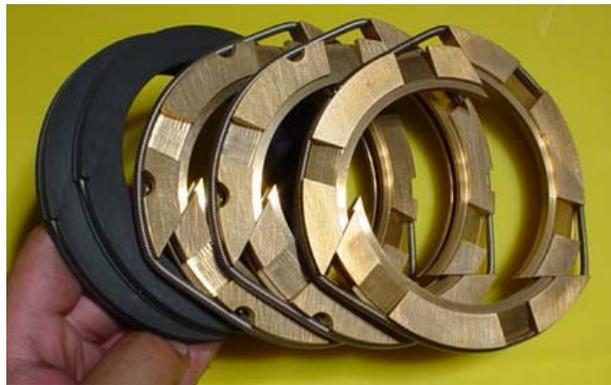
En realidad todas las empaquetaduras permiten una pequeña cantidad de fugas, sin embargo, cuando se desgasta, permite fugas en gran magnitud hacia la pieza de distancia. Los patrones característicos de esta falla son:
