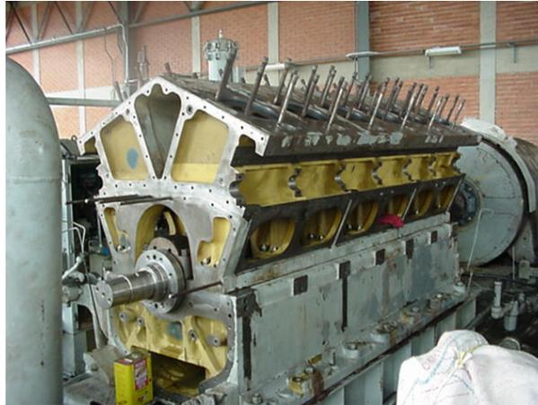
Los motores reciprocantes mayores son máquinas costosas que si no son mantenidas adecuadamente se deterioran. En la **Figura 137** se muestra un motor Modelo 12 GTL de 1850 hp y 900 rpm en reparación mayor por daños y desgaste severo en la mayoría de los componentes del conjunto de potencia.
