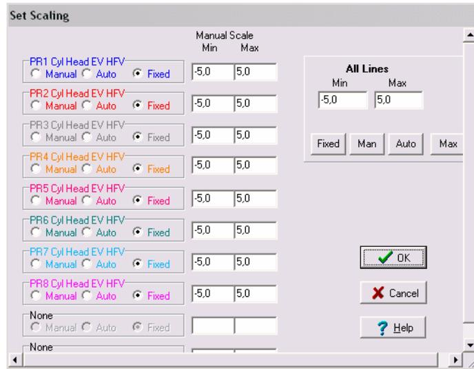
Básicamente en la ventana de diálogo de la opción de configuración de escalas de gráficos existen dos opciones, configurar una única escala para todas las líneas de la gráfica o configurar independientemente cada una de las diez curvas.
