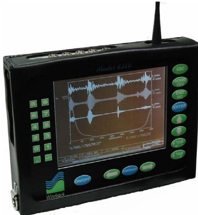
El Windrock 6310PA (Véase Figura 279) es un analizador multi canal especializado para maquinaria recíproca. Multicanal significa que el analizador es capaz de adquirir señales dinámicas simultáneas desde los cuatro canales que lo componen todas referenciadas a la señal de fase desde quinto canal (fase de la posición del cigüeñal de la máquina recíproca). La frecuencia de monitoreo a través de cualquiera de dichos canales es de 20Hz a 200Khz.
