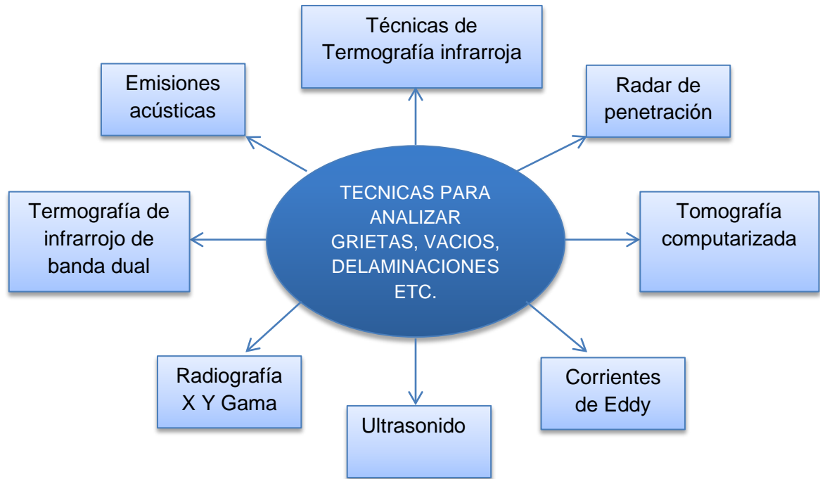
Figura 34. Técnicas para la evaluación de discontinuidades en puentes.
