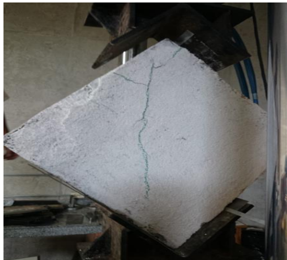
Figura 21. Muro acabado de fallar
