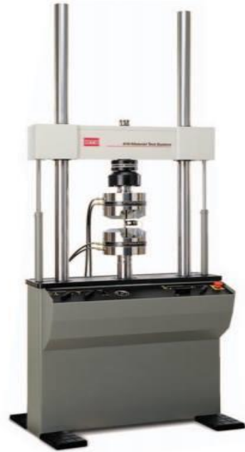
Figura 12. (a) Prensa hidráulica (b) Máquina universal (MTS)
