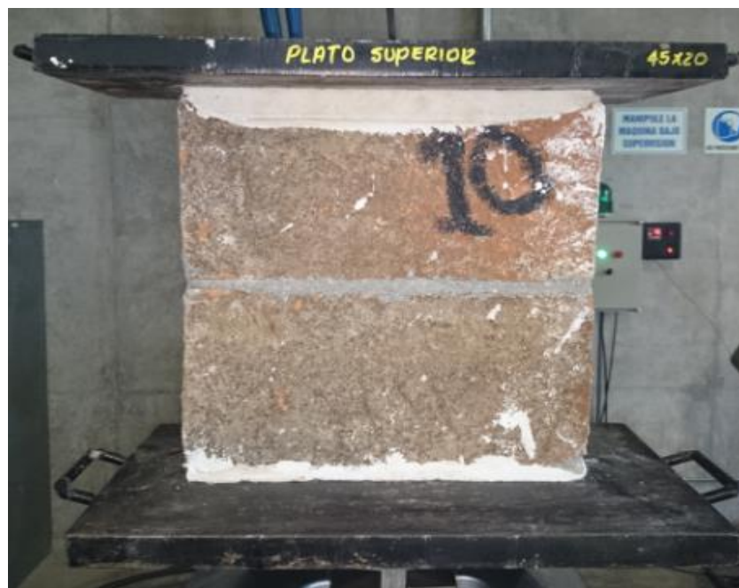
Figura 18. Pila encima del plato de carga inferior y alineada los ejes centroidales del espécimen con el centro de la máquina de ensayo
