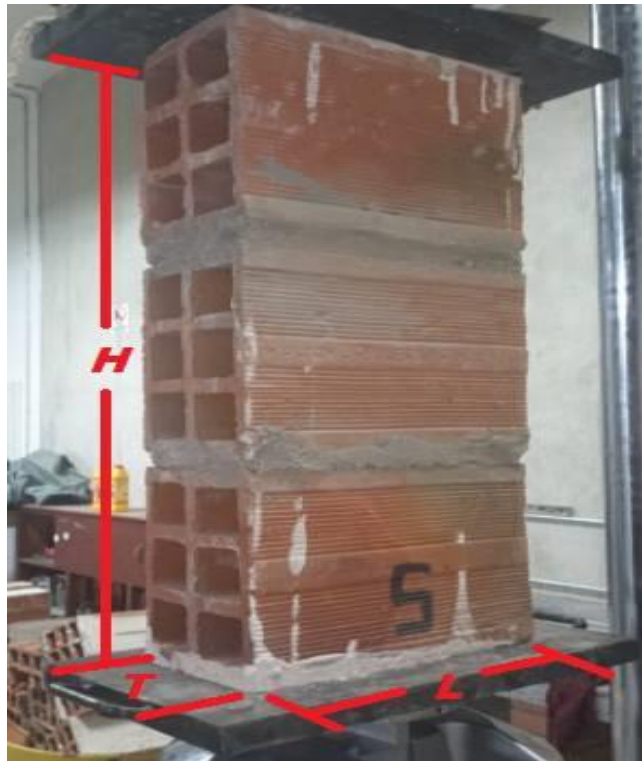
Figura 7. Altura, largo y ancho de pilas
