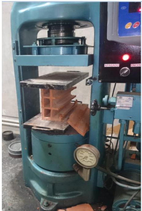
Figura 15. Ensayo de resistencia a la compresión de unidades de mampostería.
