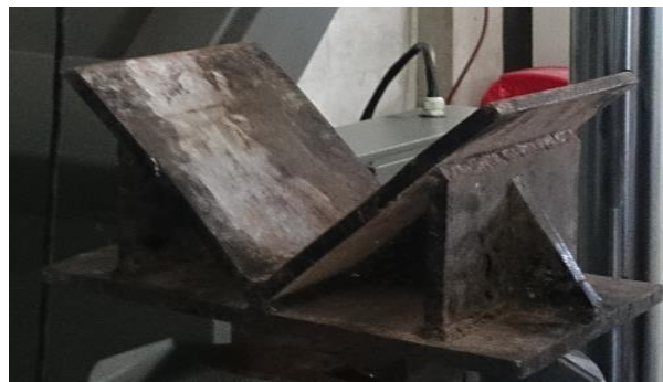
Figura 2. Platina para adaptación a la maquina universal (MTS 810)
