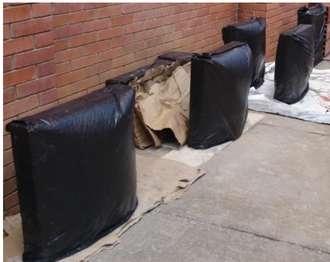
Figura 10. Sellado en bolsas impermeables durante 28 días
