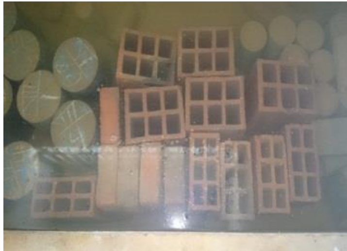
Figura 14. Se sumergen los especímenes secos y fríos
