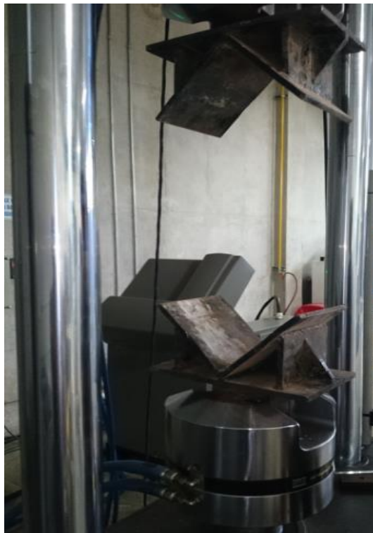
Figura 13. Platinas ubicadas en la parte superior e inferior de la MTS
