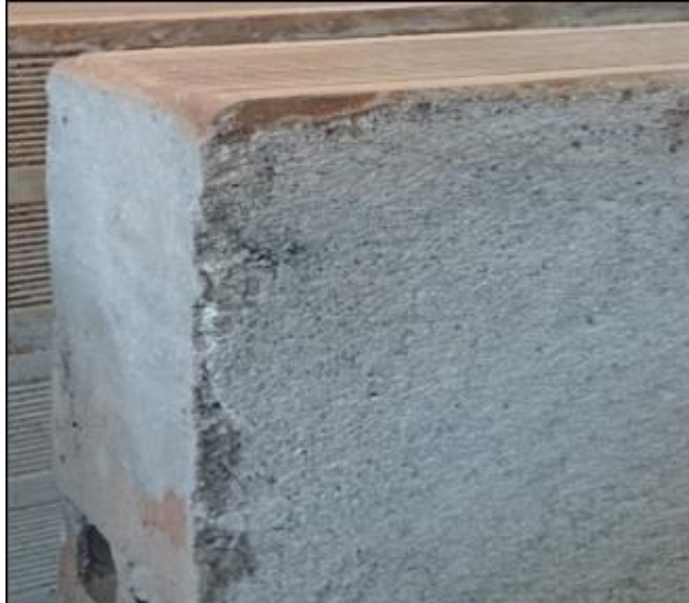
Figura 11. Refrentado de los muretes con lija
