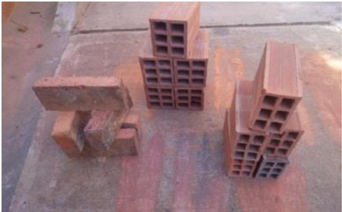
Figuran 3 Unidades de perforación horizontal (H-10, H-15), y maciza (tolete)
