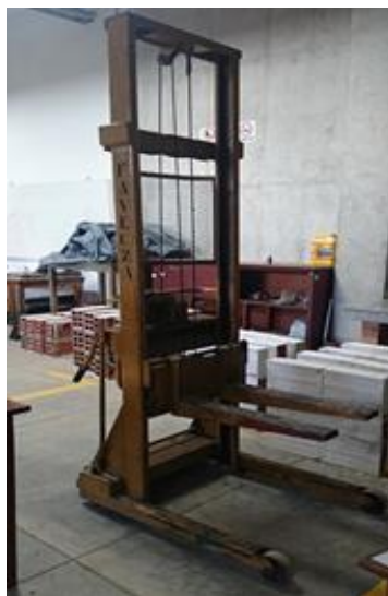
Figura 20. Monta carga para transporte y montaje de los especímenes.
