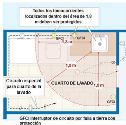
Figura 6. Ubicación de los tomacorrientes con protección en los lavaplatos diferentes a los de las cocinas.
