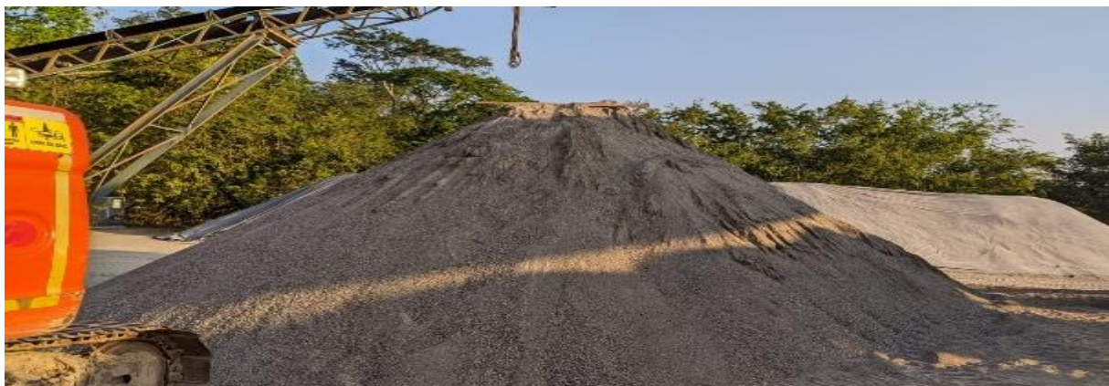
Acopio de triturado 3/8"
