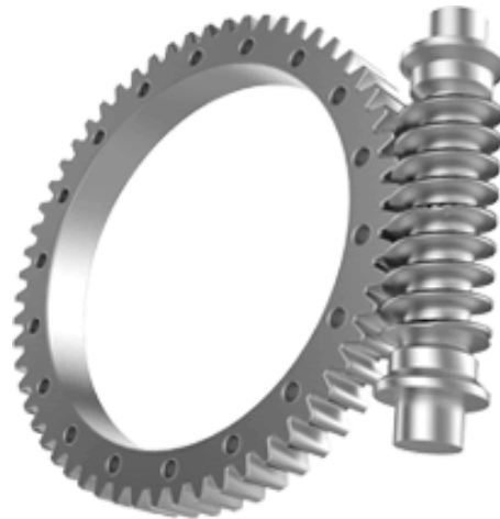
Figura 19. Mecánica de reductores tipo sinfín corona.
