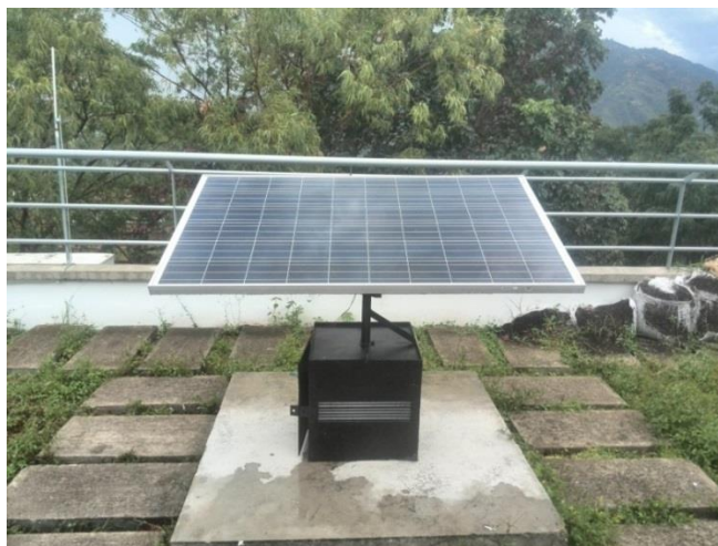
Figura 38. Seguidor solar dispuesto para pruebas de campo.
