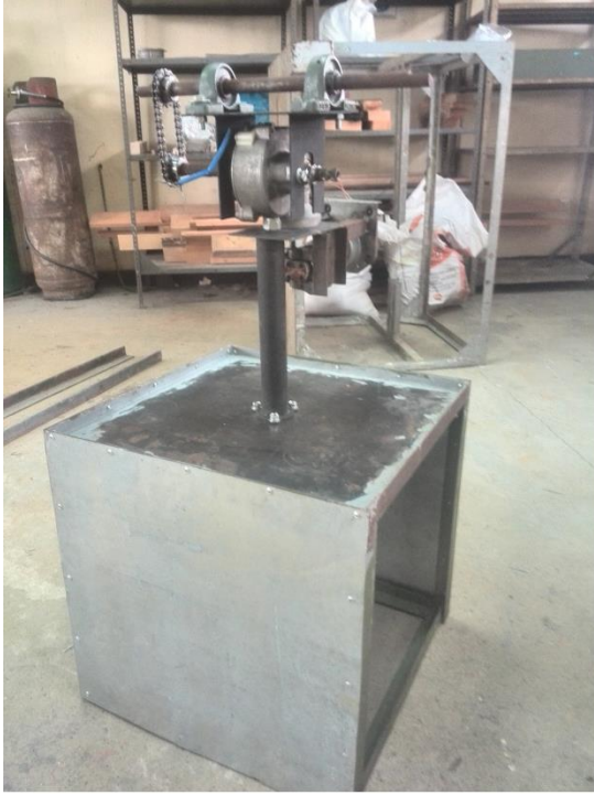
Figura 25. Seguidor solar ensamblado.
