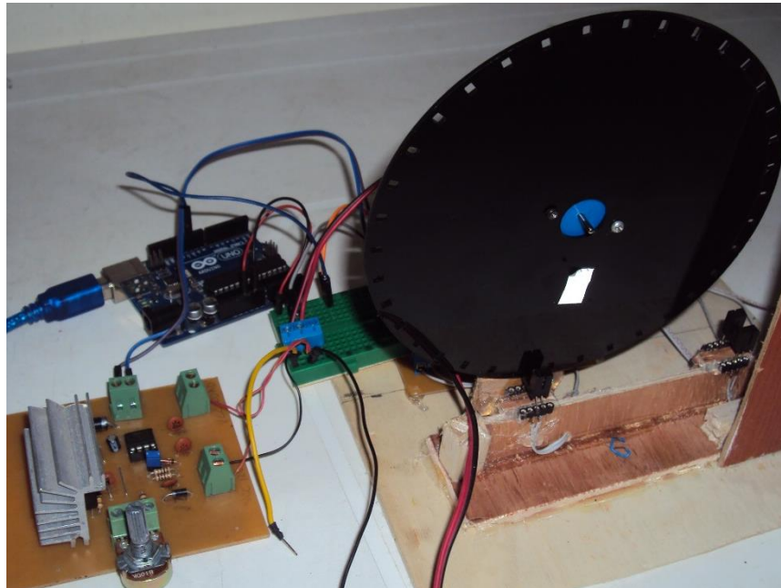
Figura 61. Montaje para pruebas de lectura de RPM
