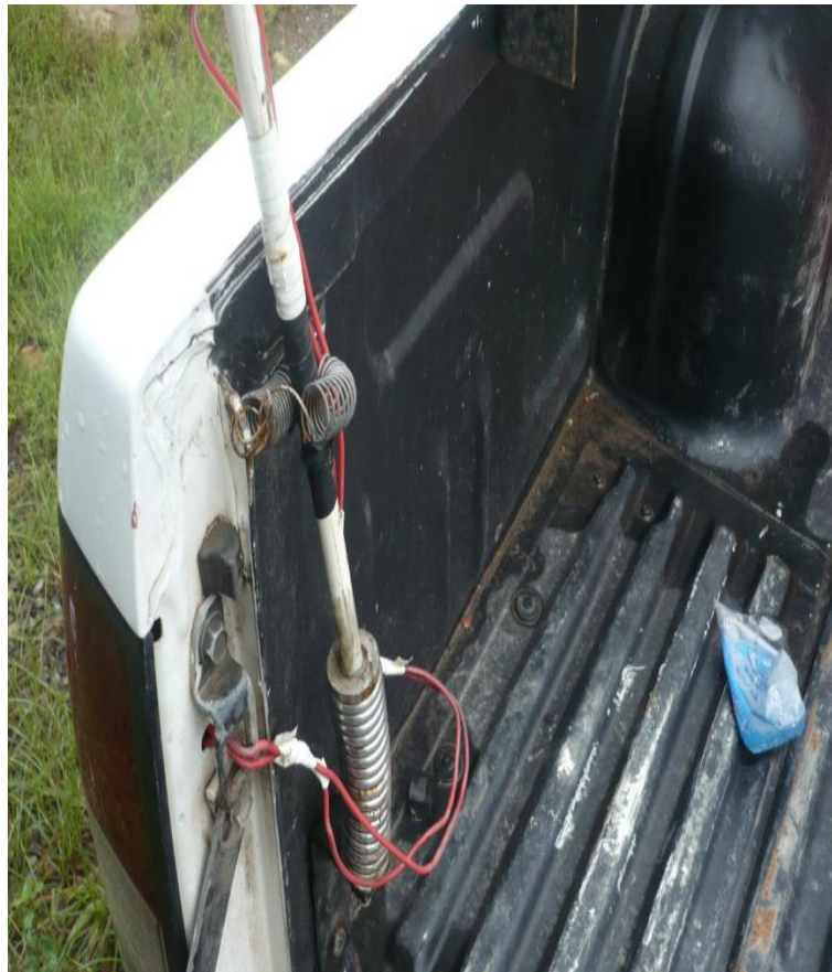
Figura 41. Mala instalación eléctrica en los vehículos
