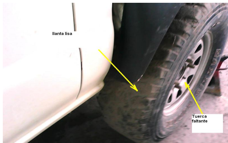
Figura 43. Desgaste de llantas y asegurada con tuerca faltantes
