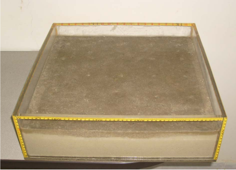
Figura 34. Celda empacada con arena, aceite y salmuera. 20
