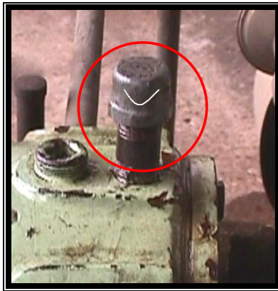
Figura 9. Ranura hecha con una herramienta de corte.
