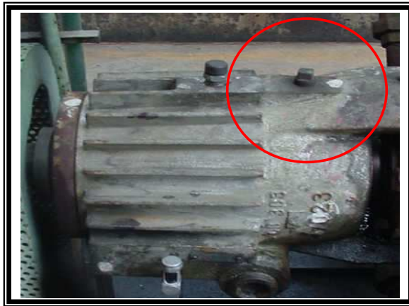
Figura 18. El equipo rotativo no tiene el rótulo del tipo de aceite lubricante.
