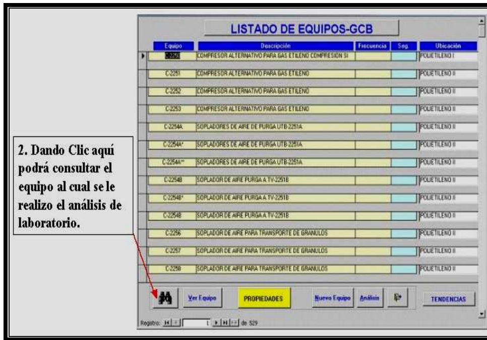
Figura 15. Inicio de la consulta de los equipos a los cuales se les realizo la toma de muestra de aceite
