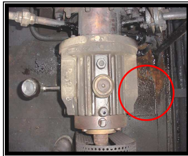
Figura 13. Caja de rodamientos con botella y sin visor de nivel de aceite.
