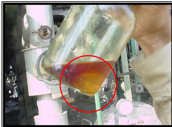
Figura 6. Aceite contaminado con Agua.
