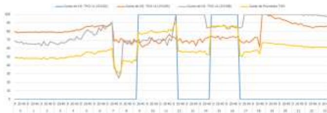
Figura 86. Distorsión armónica total por fase, día especificado.
