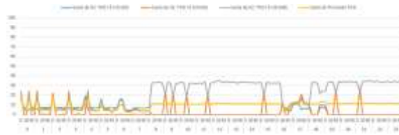
Figura 74. Distorsión armónica total por fase, día especificado.
