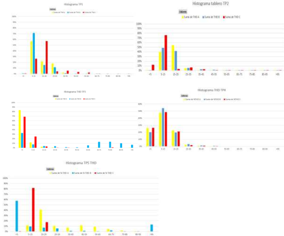
Figura 64. Histogramas de frecuencia Tableros TP1, TP2,TP3,TP4,TP5.
