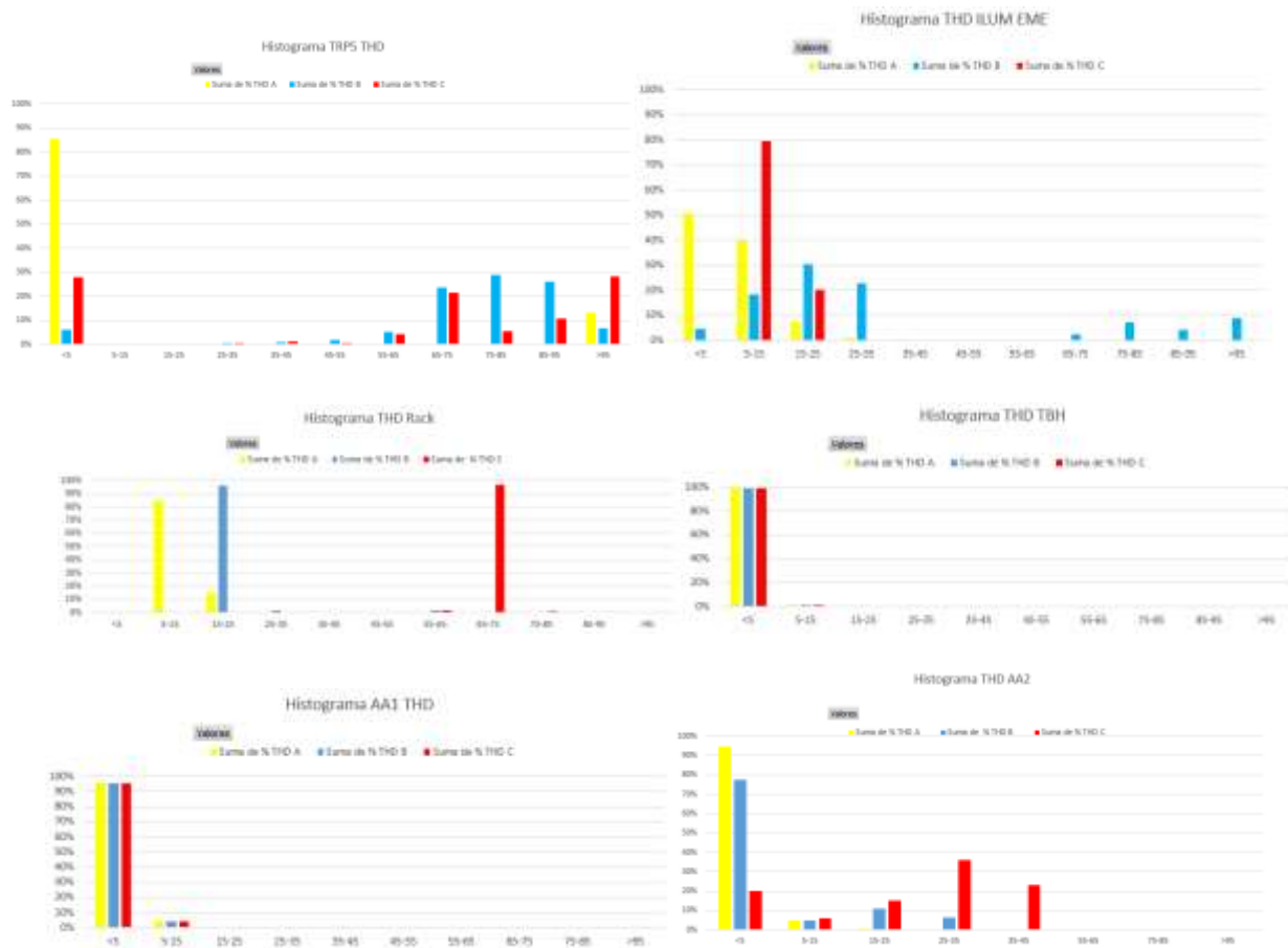
Figura 65. Histogramas de frecuencia, tableros TRP5, RACK, ILU EME, AA1, AA2, TBH.
