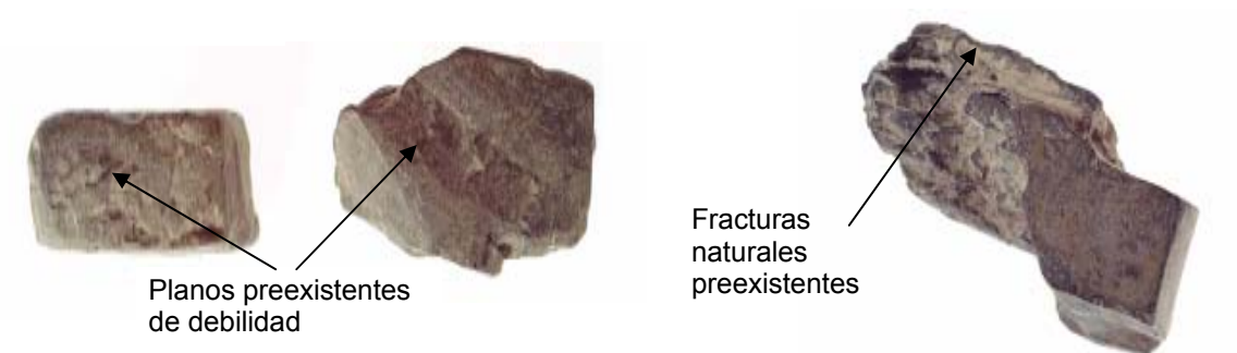
Figura.3.3. Cavings en bloque de planos de debilidad: estratificación o fracturas Naturales.
