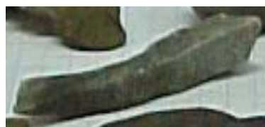
Figura 3.6. Caving de shale astilloso.
