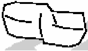
Figura 3.2. Apariencia de los cavings tipo bloque.
