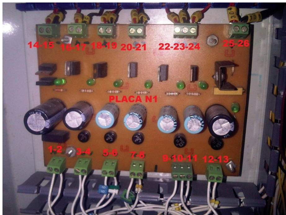
Figura 28. Fotografía de la Tarjeta N°1 del módulo de arranque y frenado
