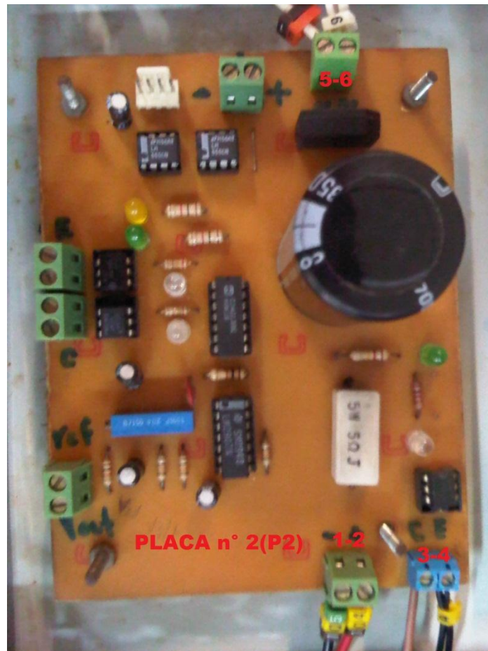
Figura 30. Fotografía de la tarjeta N°2 circuito rectificador para la corriente de campo del motor de corriente continua.
