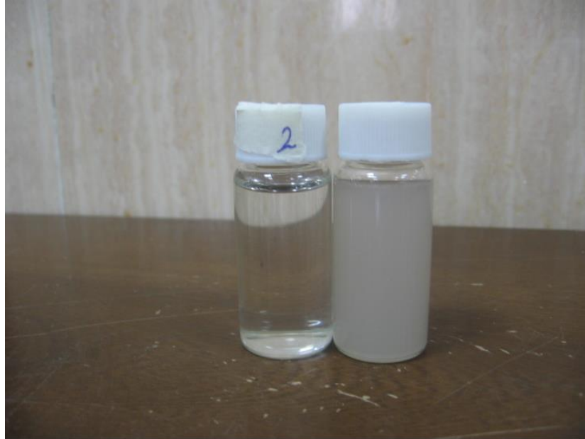
Figura 18. Muestras de agua con efluentes caso de referencia vs aplicacion de NP.
