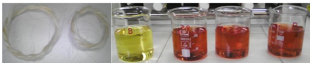
Figura 30. Izquierda, fibras de fique sin sintetizar; derecha, soluciones: blanco, muestras degradadas a pH 2,9, 3,5 y el patrón de fenol a 20 ppm.
