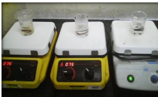
Figura 9. Montaje experimental para los ensayos de degradación de una solución estándar de fenol.
