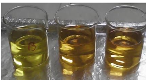
Figura 28. Concentración inicial de fenol por colorimetría, De izquierda a derecha: blanco, muestra real y duplicado.
