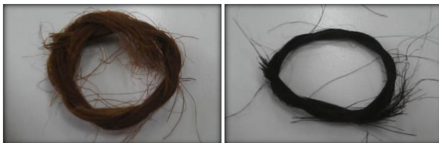
Figura 8. Izquierda, nanocomposito de fique- \text{Fe}_3\text{O}_4 ; derecha, nanocomposito de fique- \text{MnO}_2
