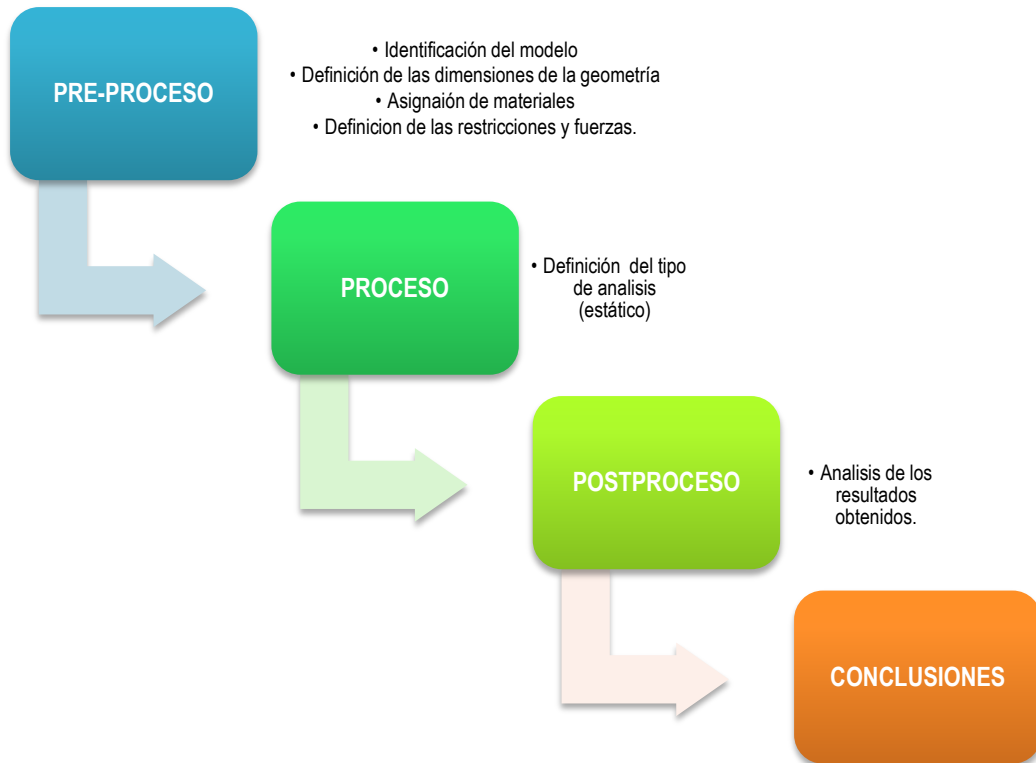
Figura 15. Etapas del cálculo por elementos finitos, aplicadas al caso estudio
