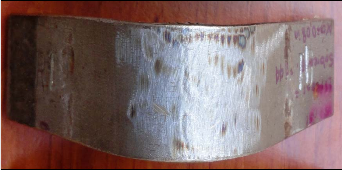
c. Doblez de raíz de probeta con estampe R1-TIG
