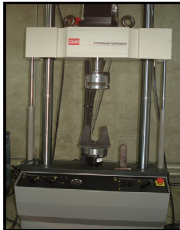
Figura 6. Fotografía equipo para pruebas de doblé de uniones soldadas
