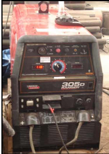
Figura 3. Equipo para soldar con los procesos GMAW y GTAW
