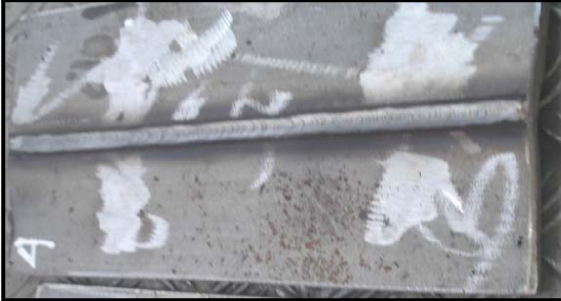
Figura 16. Foto de un cupón soldado por SMAW.
