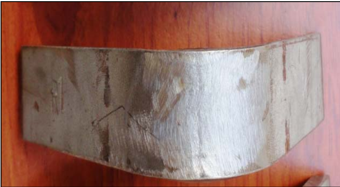
c. Doblez de raíz de probeta con estampe R1-M
