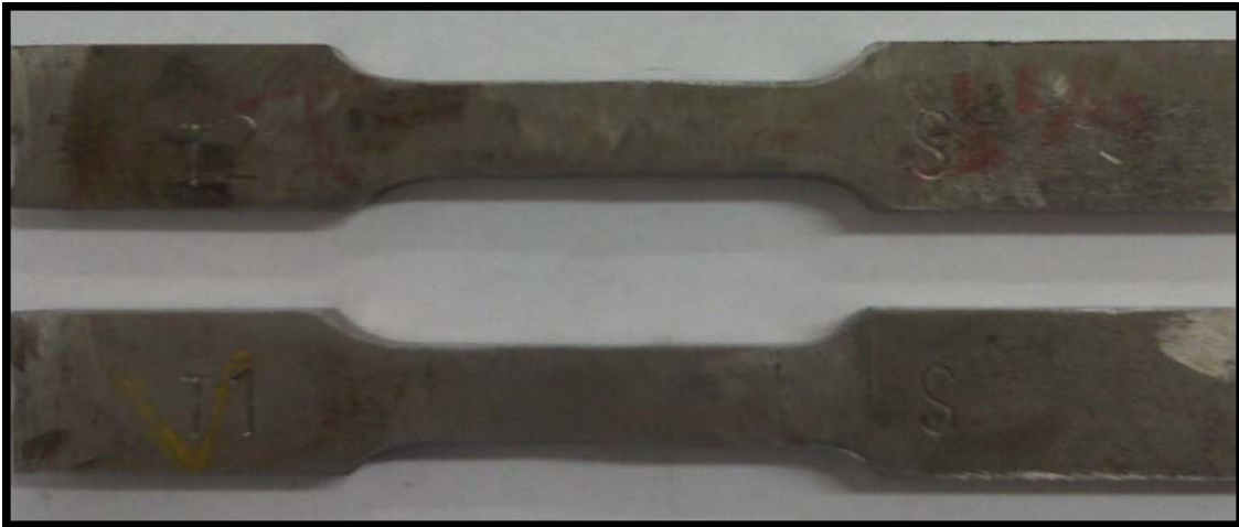
Figura 19. Foto probeta para ensayo de tracción soldada por SMAW
