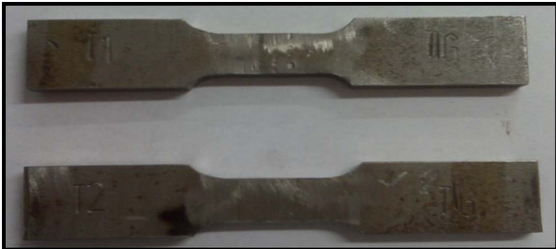
Figura 20. Foto probeta para ensayo de tracción soldada por TIG
