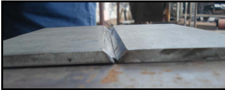
Figura 13. Foto de un cupón de prueba listo para soldar
