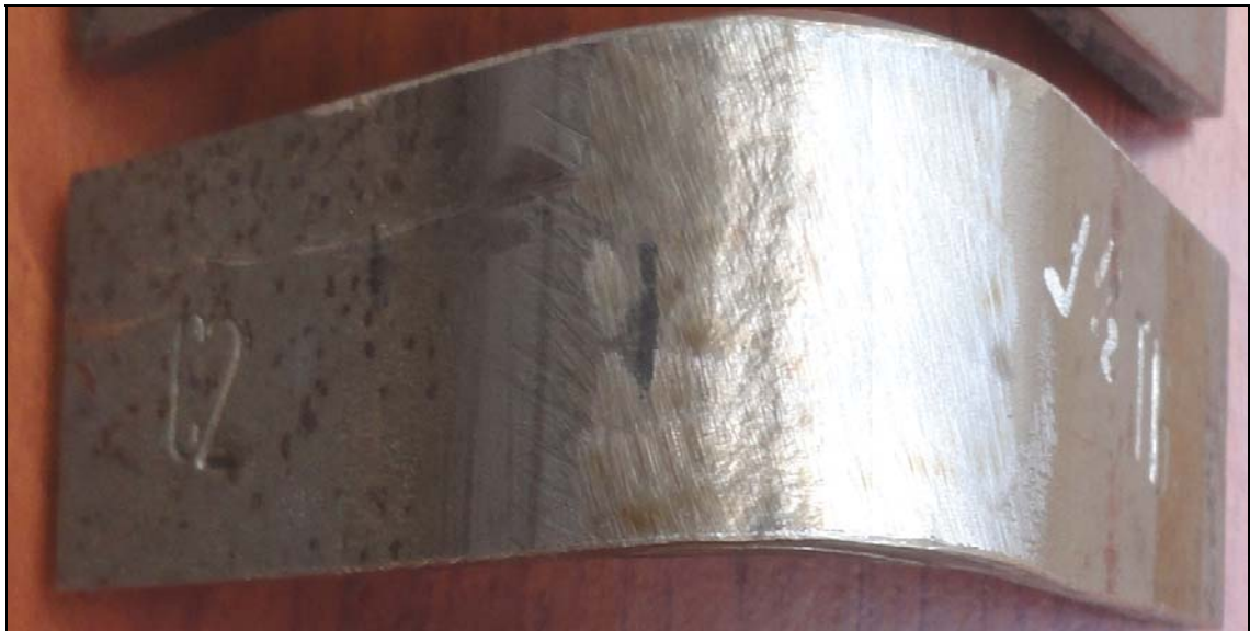
b. Dobléz de cara de probeta con estampe C2-TIG
