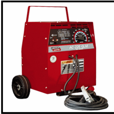
Figura 2. Equipo para soldar con arco eléctrico y electrodo recubierto SMAW
