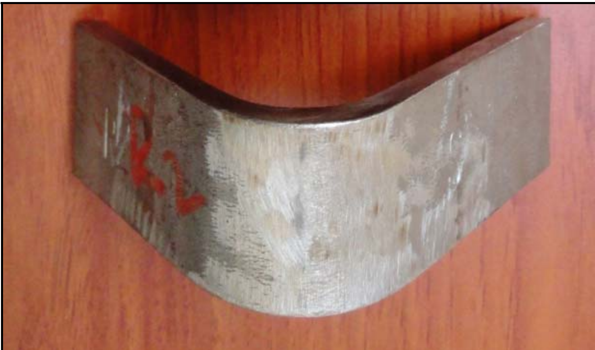
d. Doble de raíz probeta con estampe R2S
