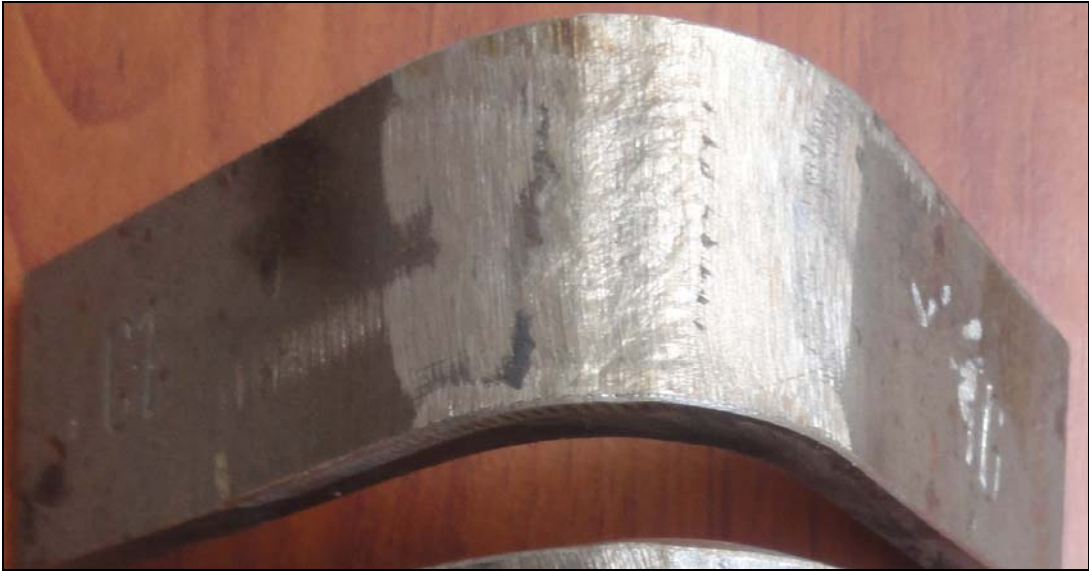
a. Dobléz de cara de probeta con estampe C1-TIG
