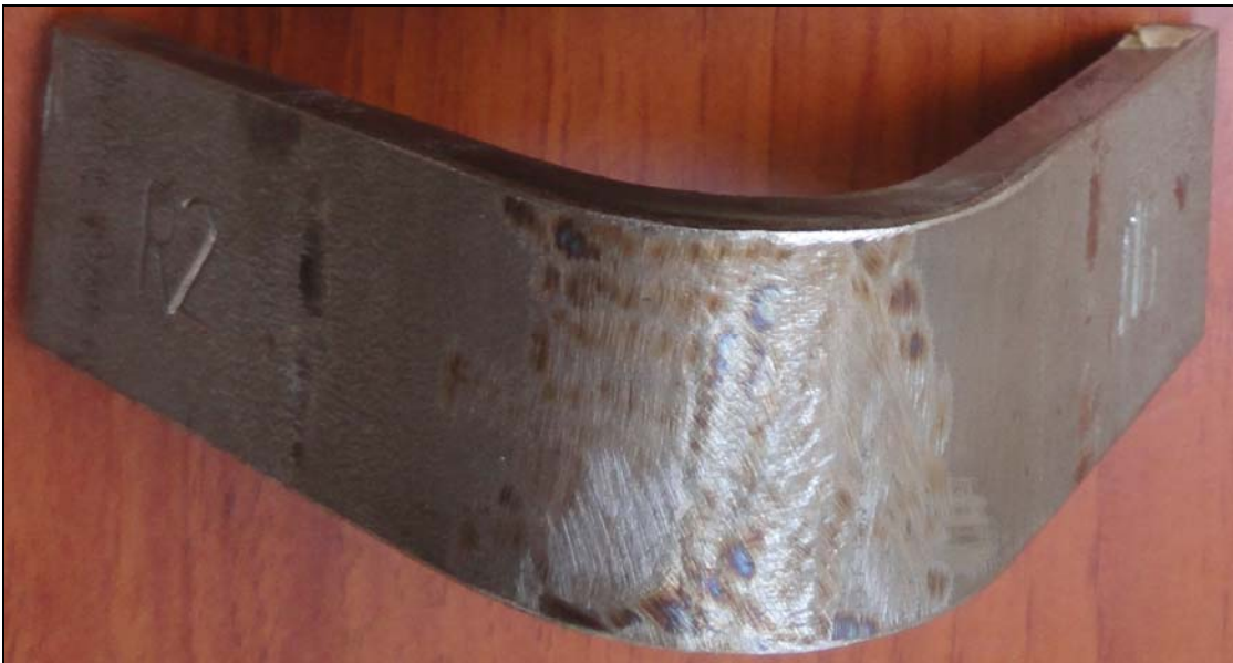
d. Doblez de raíz de probeta con estampe R1-TIG
