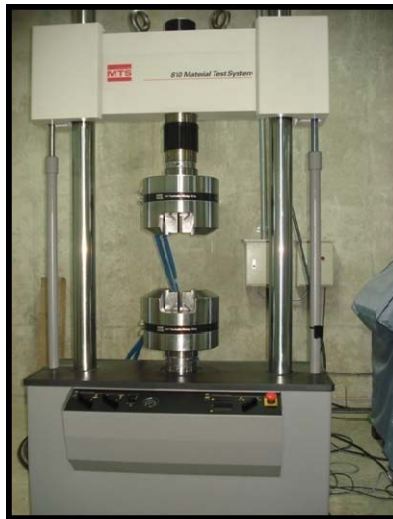
Figura 5. Fotografía equipo para ensayo de tracción
