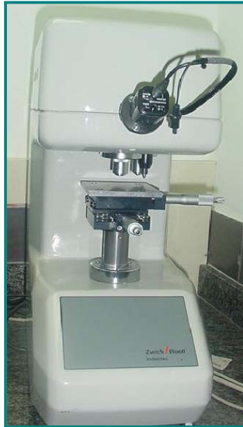
Figura 7. Microdurómetro ZWICK ROELL ZHV dois
