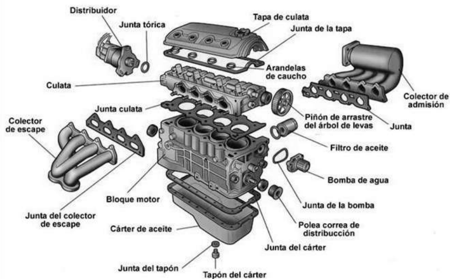
Figura 4. Explosionado de un bloque de un motor a gasolina de cuatro cilindros. 11
