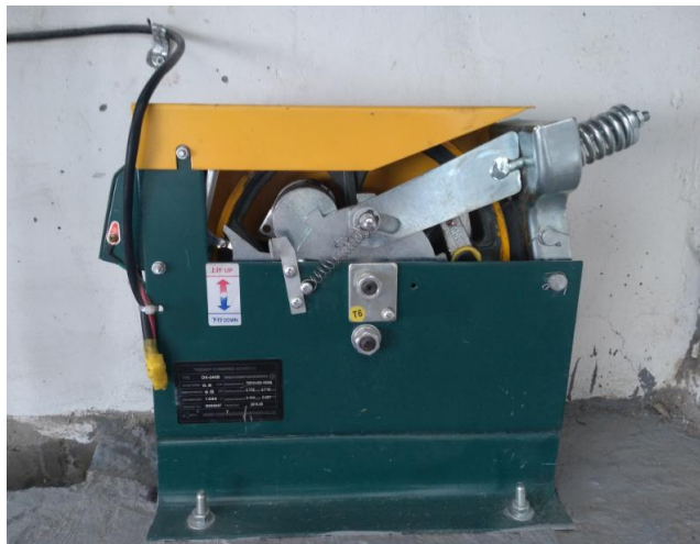
Figura 27. Limitador de velocidad
