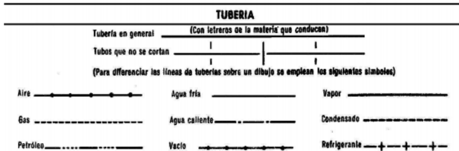
Figura 3. Simbología de las líneas en tuberías
