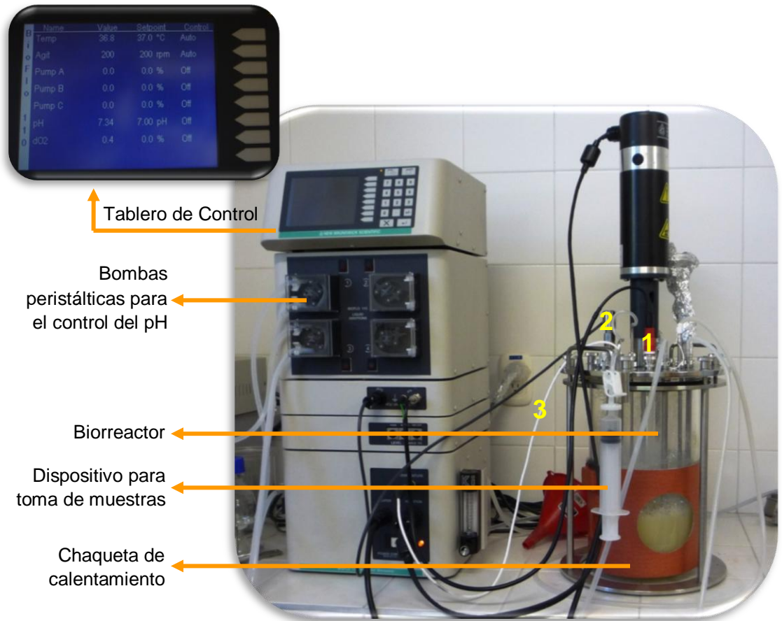
Montaje experimental para la fermentación ABE. 1) Sensor de Oxígeno; 2) Sensor de pH; 3) Sensor de Temperatura.
