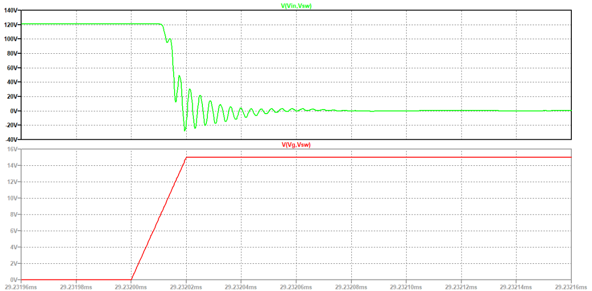
Figura 54 Tensión ampliada Puerta-Surtidor (roja) y Tensión ampliada Drenador-Surtidor (verde) para R_{max} de 200 [\Omega] y D del 70% obtenida en simulación.
