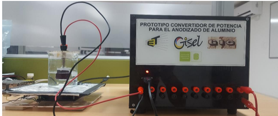
Figura 66 Montaje en solución química para la realización del anodizado.
