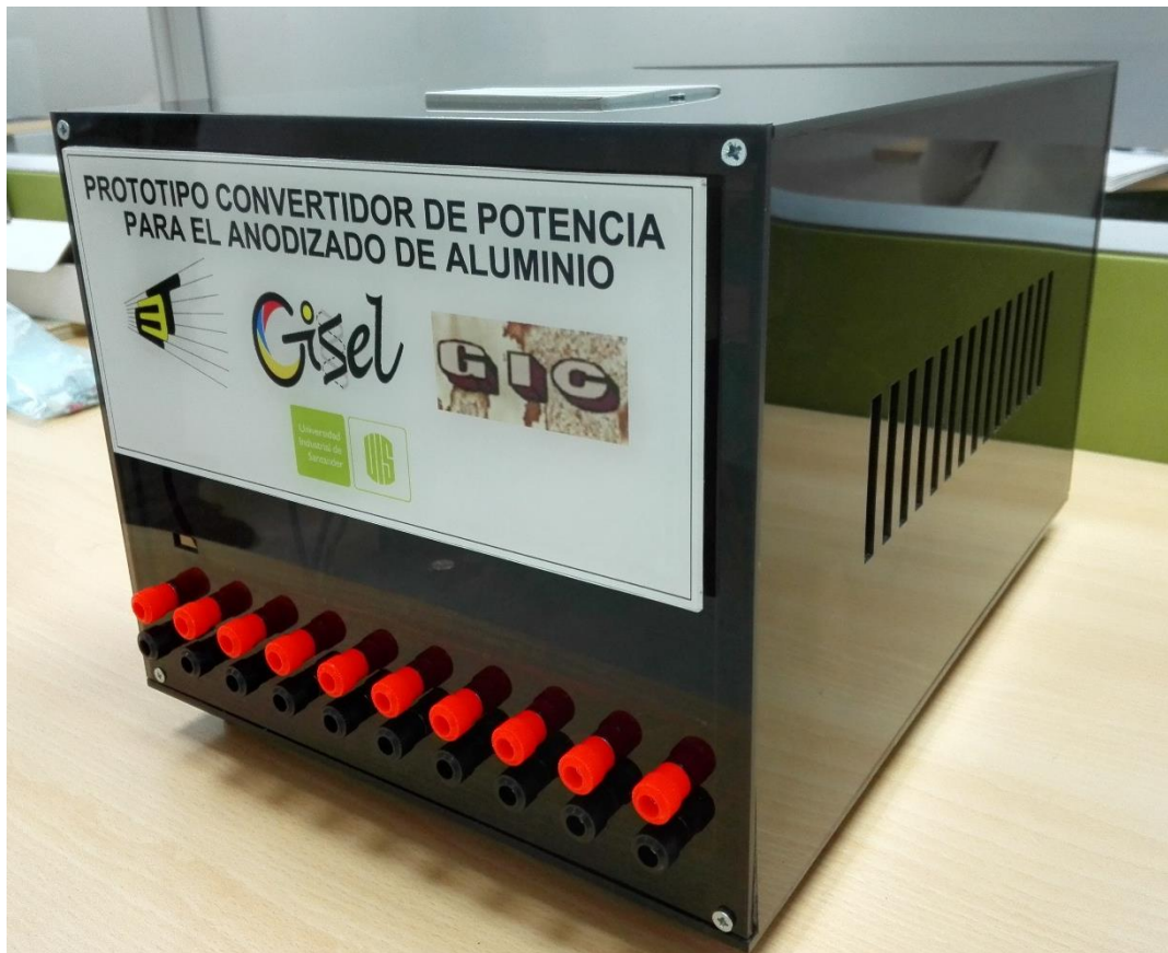
Figura 34 Prototipo final implementado para el anodizado de aluminio.
