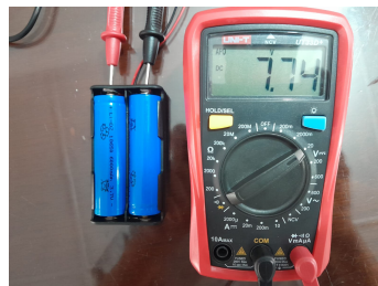
Figura 19: Voltaje suministrado al módulo exterior
