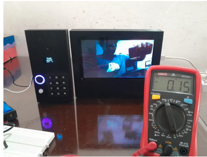
Figura 20: Corriente consumida por el módulo exterior
