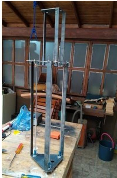
Con el fin de reducir costos para poder replicar el modelo en la flota de cámaras 360 de la empresa, se pensó en la implementación de una rotación manual ya que de esta forma de ahorraría el dinero de los componentes como el actuador lineal inicialmente planteado. Sin embargo, se evaluó el tiempo que tardaría el operario en poder realizar esta maniobra, es por ello por lo que se implementó una prensa de liberación rápida como se muestra en la Figura 40.
