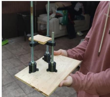
Los tres tornillos de potencia son alimentados por un motor paso a paso, que tiene la capacidad de moverse de manera controlada la cantidad de revoluciones o fracciones de revolución necesarias para que el avance de los hilos del tornillo lleve a la cámara a cualquier altura deseada. El motor y los demás componentes electrónicos son calculados más adelante.
