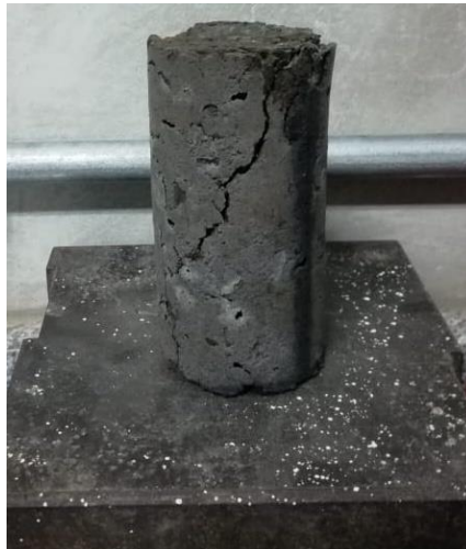
Imagen 11. Probeta con contenido de PET después del ensayo de compresión inconfiada
