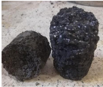
Imagen 3. Probeta de suelo areno arcilloso con 45% de PET triturado.
