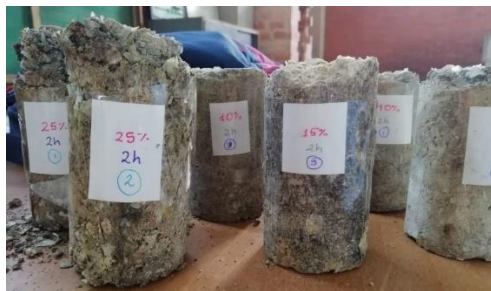
Imagen 4. Probetas con diferentes porcentajes de contenido de PET sometidas a 2 horas en el horno
