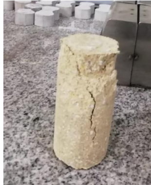
Imagen 10. Probeta fallada de suelo areno arcilloso sin adición de PET triturado
