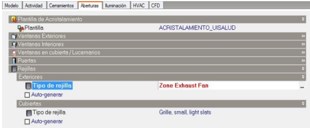
Ilustración 17. Corrección del error rejillas de ventilación
