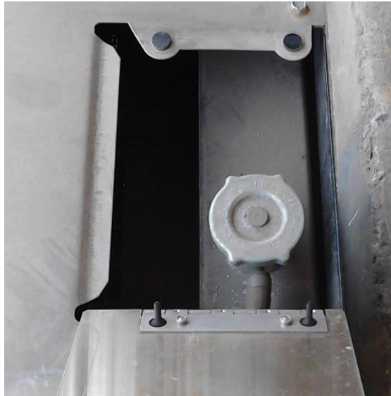
Imagen 27. Depósito de Refrigerante
