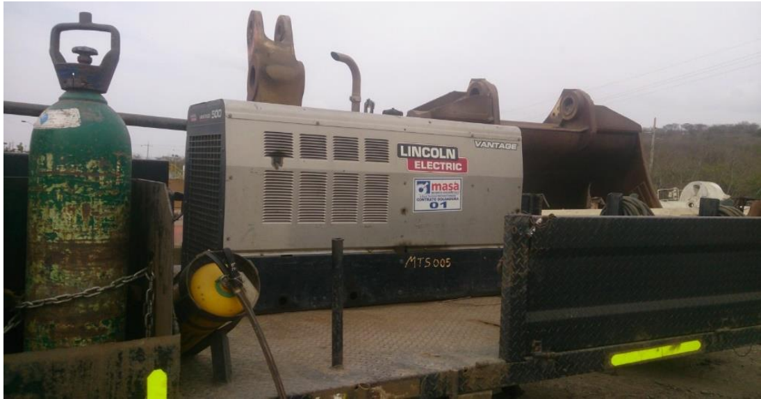
Imagen 1. Motosoldador montado sobre planchón de camión
