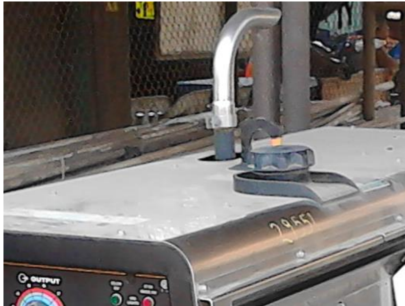
Imagen 26. Tubo de escape Motosoldador
