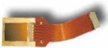
Figura 3: Sensor capacitivo de la compañía Infineon, referencia FingerTIP 8 .
