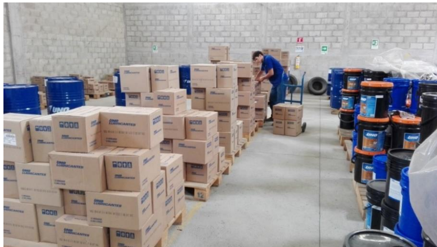
Figura 27. Método de almacenamiento apilado con estibas de madera
